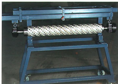
A special wheeled cart enables quick replacement of the unit and makes for easy and safe maintenance and replacement of the four cut plates. Un chariot spécial avec roues permet de réaliser rapidement le remplacement du groupe dans la machine et d'assurer facilement et en toute sécurité l'entretien et l'échange des plaquettes de quatre coupes.
