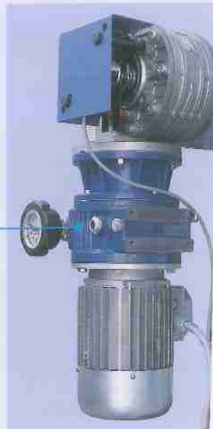
Feed variable speed Motovariatore avanzamento Regelgetriebe Motovariateur entraînement Motovariador tapete
