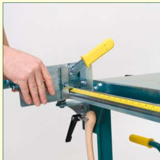
Das aufsetzen des Rollenschlittens
