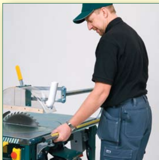
Av- og påmontering av styreskinne
