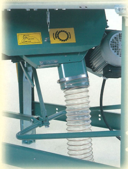
Ø100 mm Anschluss für Spanabsaugung
