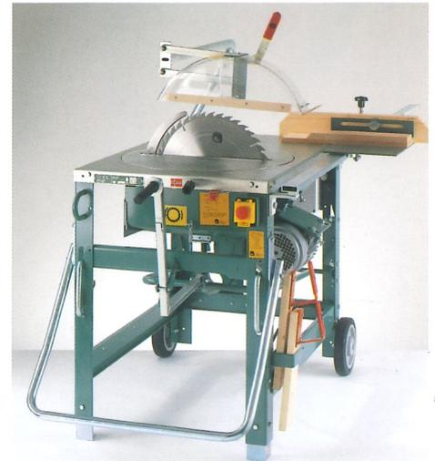
**Gjerde 1603-NL mit Fahrvorrichtung und Hehebügel,** Gewichtsreduzierung durch Hehebügel von ca. 140 kg auf 40 kg
