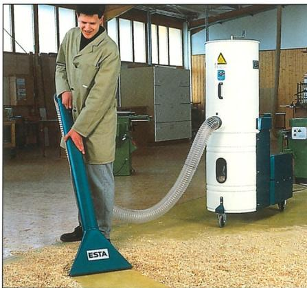
Durch Ankoppeln eines leitfähigen Bodenreinigungs-Sets kann mit dem DUSTOMAT-10 der Werkstattboden abgesaugt werden.
