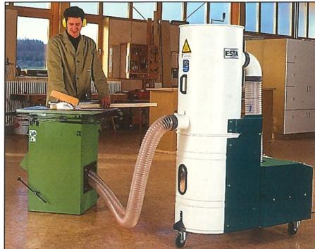
Der fahrbare Entstauber DUSTOMAT-10 kann an den unterschiedlichsten Maschinen angeschlossen werden.
