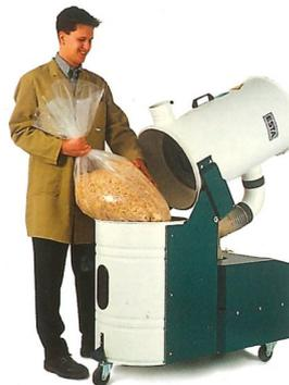
Die Entnahme des gefüllten Staub-/Spänensammlers ist einfach: Das Filtergehäuse wird mit einem sekundenschnellen Handgriff abgekippt und der Sammelsack entnommen.
