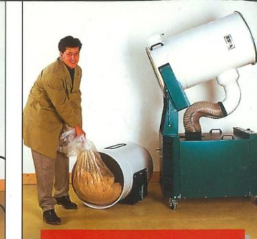
Zur leichteren Entnahme eines zu schwer gewordenen Sammelsackes kann der Behälter auch gekippt werden.
