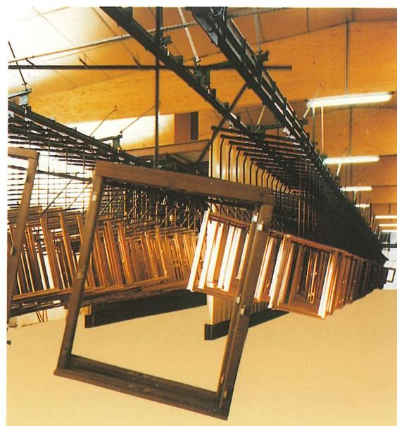
Impianti aerei di verniciatura ed essiccazione ad aria calda per infissi in legno.
