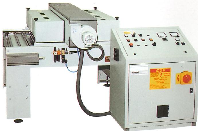
Cappe di essiccazione con lampade IRM e aria calda forzata ad alta velocità, mod. TRI-AJ.
