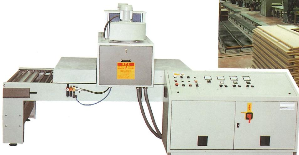
Cappe di irraggiamento con lampade U.V. ad alta potenza, modello CUV e STL.
