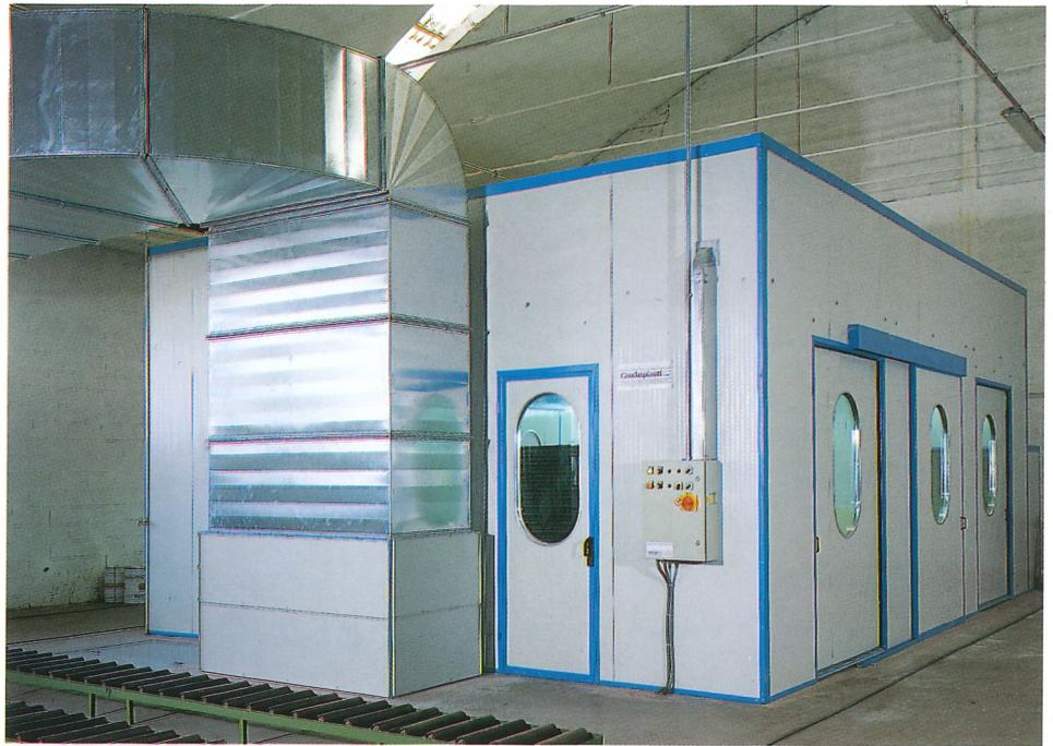
Centrali complete di trattamento aria in esecuzione modulare per finiture a lucido diretto modello GTA.
