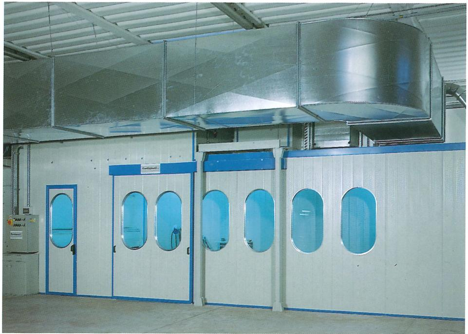
Cabine di verniciatura pressurizzate con ventilazione verticale, modello LPI.
