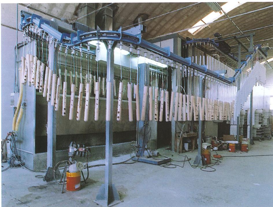
Impianto di verniciatura ed essiccazione per accessori in legno con trasportatore aereo.
