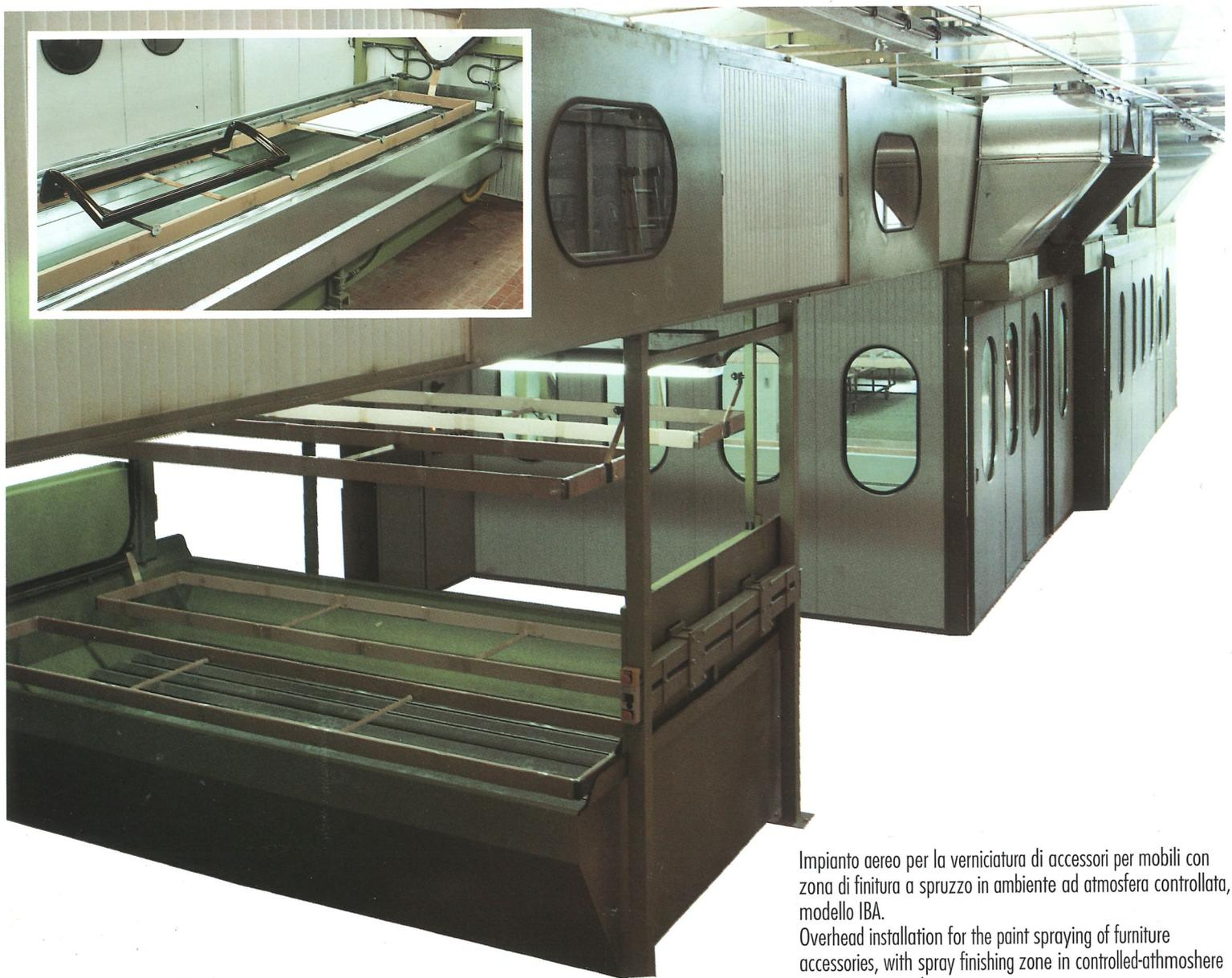
Impianto aereo per la verniciatura di accessori per mobili con zona di finitura a spruzzo in ambiente ad atmosfera controllata, modello IBA.
