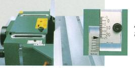
Anschlagschienen in "+ 25 mm Einstellung" für Fügespanabnahme im Rechtslauf
