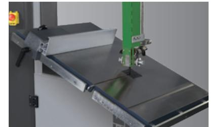
0° bis +20° Schwenkung des Grauguss-Bandsägetisches mit präzise geschliffener und polierter Oberfläche.
