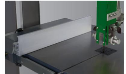
Der leicht verschiebbare Aluminium-Parallelanschlag ist links und rechts vom Sägeblatt einsetzbar. Einfaches Umlegen des Anschlages für flache Werkstücke und abschwenken unter die Tischoberfläche sind die Argumente, die überzeugen.
