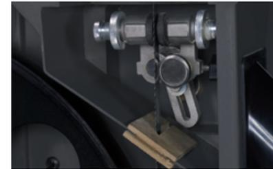
Die Felder-Bandsägen sind mit einer Ober- und einer Untersägeblattführung mit feineinstellbarer Seiten- und Rückenrollenlagerung und arretierbarer Einstellschraube ausgestattet.
