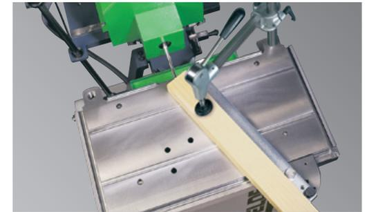
Den Winkelanschlag befestigen Sie sekundenschnell mit dem Einhandklemmhebel am Maschinentisch. Die meistverwendeten Winkel  $-45^\circ$ ,  $-22,5^\circ$ ,  $0^\circ$ ,  $22,5^\circ$  und  $45^\circ$  sind durch eine Rasterstellung vorwählbar, alle anderen Winkeleinstellungen können mit der Skala vorgenommen werden.
