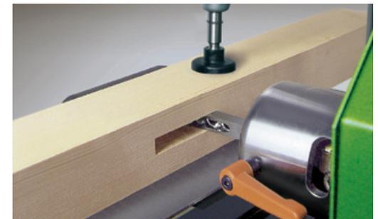
Stemmen von quadratischen bzw. rechteckigen Bohrungen ist mit der Zusatzeinheit für Stemmarbeiten möglich. Bei Zapf- und Schlitzverbindungen muss der Zapfen nicht mehr abgerundet werden, da der Schlitz „eckig“ gestemmt wird. Dies spart zeitaufwendige Handarbeit.
