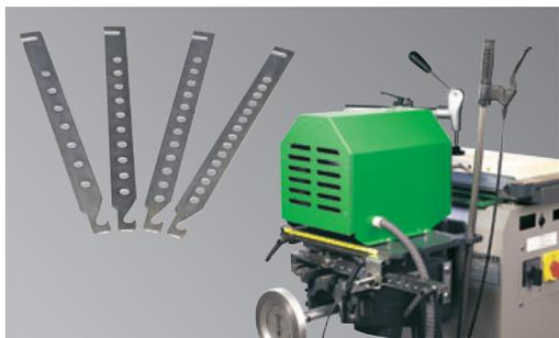
4 Rasterlineale mit Lochabständen 16 mm, 22 mm, 25 mm und 32 mm gehören zum Standardlieferumfang der Dübelbohrereinrichtung, Sonderlochabstände sind auf Wunsch lieferbar. Die Fernbedienautomatik am Handgriff der Einhandhebelbedienung gewährleistet ein komfortables und einfaches Arbeiten.
