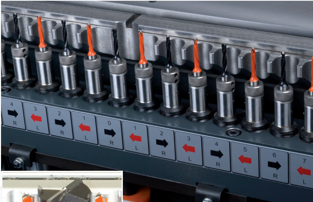
Anschlagtiefe bis 300 mm mit Skala einstellbar.
