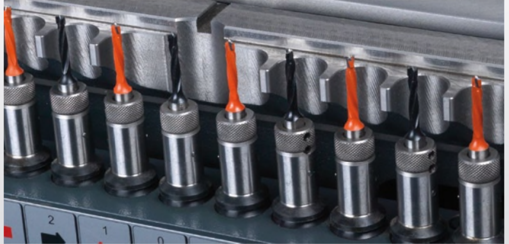
Auf Wunsch: Kombiboehrsegment für Topfbandbohrungen.
