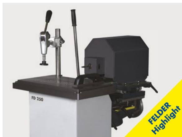
**Rollengelagerter Bohrmotor mit Rechts-, Linkslauf und komfortabler Einhandhebelbedienung**
