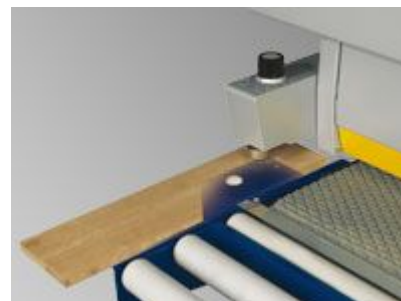
Automatische Dickenmessung für höchste Präzision und Produktivität
