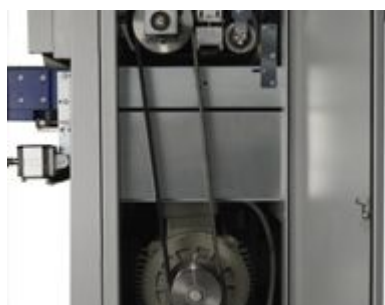
Moteurs puissants et transmission continue de la force pour d'excellents résultats de ponçage
