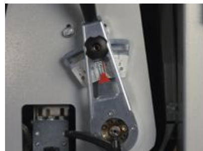
Sencillo y preciso: el ajuste rápido del agregado
