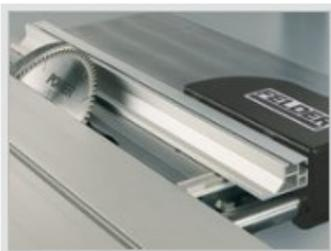
Für die Bearbeitung von besonders schmalen Werkstücken bei geschwenktem Kreissägeblatt kann das Alu-Kreissägeleinal in die liegende Position gebracht werden.
