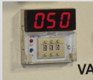
Temperaturanzeige Digitale Temperaturanzeige der Heizung für konstant optimale Verleimtemperatur.
