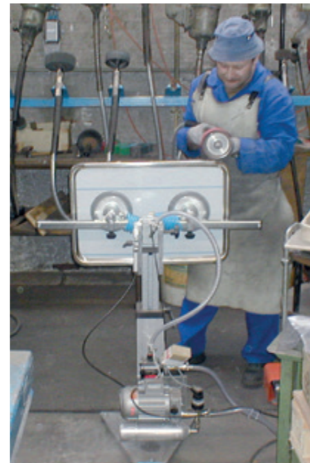
VacuStand VS-I-75KG mit Aufsatz II für Schleifarbeiten an Aluminium-Grundplatten
