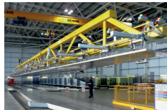
VacuGiant VG-5000KG für den Transport von bis zu 36.000 mm langen Aluplatten zur Herstellung von Tragflügelementen für den Airbus A380
