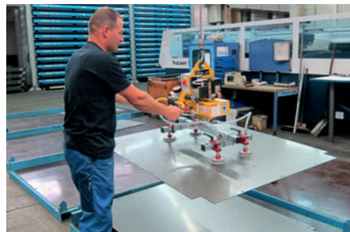
VacuBoyMini VBM-ACCU-125KG mit Vierfach-Sauggreifer für die Beschickung einer CNC-Anlage
