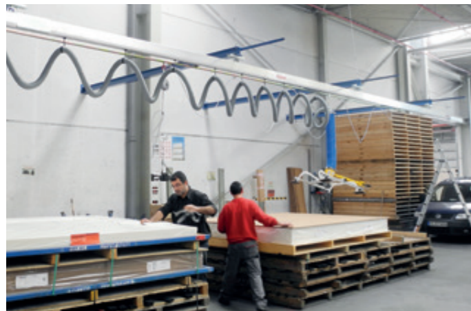
HBS-ES-125KG-12000 Einschienekrane für das Umlagern von Plattenmaterial
