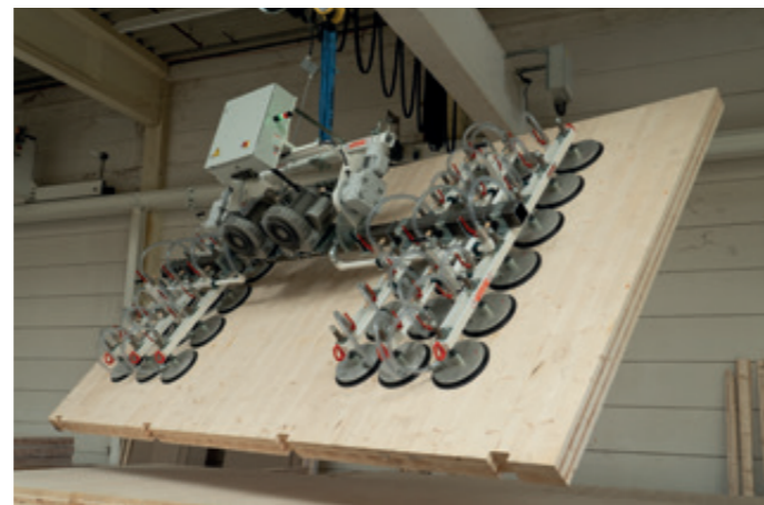
VacuGiant VG-90E-2500KG mit 2 Gebläsestufen in der Endmontage von Holzcontainern
