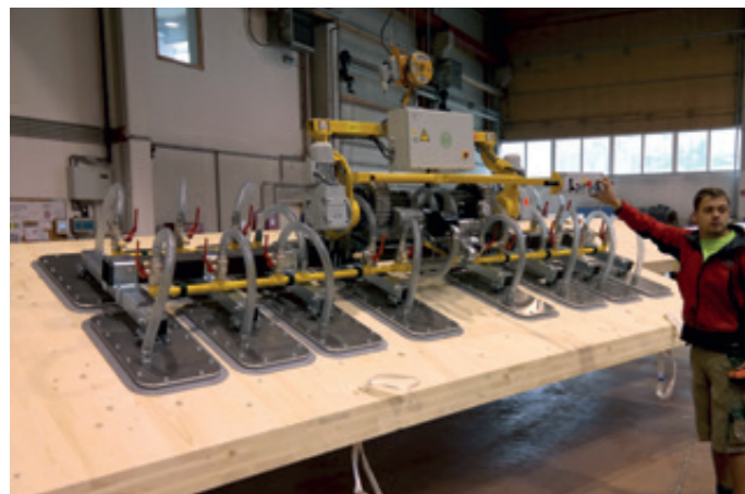
VacuGiant VG-90E-3500 für das Schwenken von bis zu 250 mm starken Holzplatten
