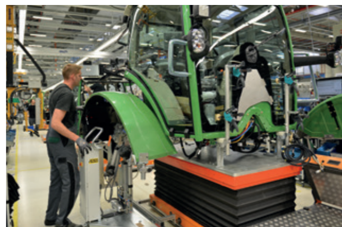
VacuStand VS-I-AL-FTS mit ACCU-Modul und elektrischer Höhen- und Schwenkverstellung
