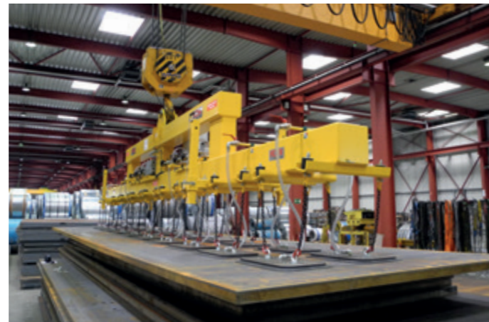
VacuGiant VG-25000KG mit doppelreihiger Sauggreifer-Anordnung für Bleche bis 20000 x 3000 x 50 mm
