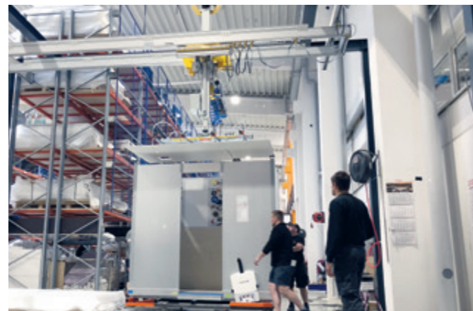
Lifffix LF-ET-80KG Starres Hubsystem mit Doppelteleskop für die Handhabung von Deckenelementen in der Endmontage
