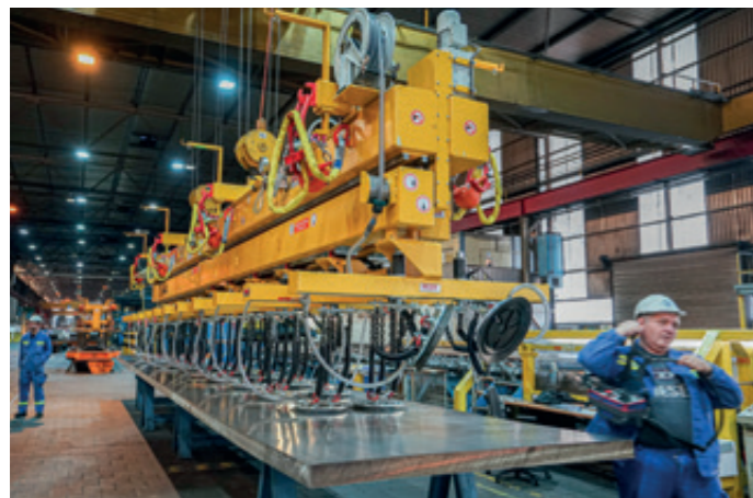
VacuGiant VG-12000KG-TEL elektromotorisch ausziehbare Vakuumtraverse für Bleche von 8.000 - 14.000 mm mit zusätzlichen Paketgreifern
