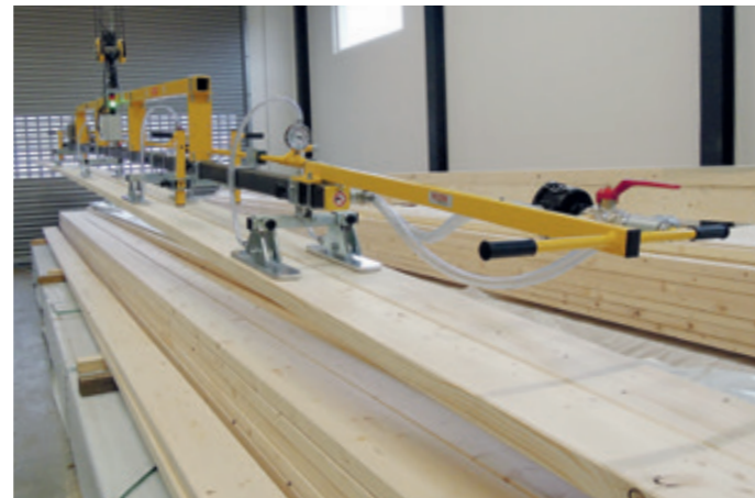
VacuWood VWLB-500 mit Doppel-Sauggreifern, gleichzeitiges Heben doppel-lageriger Hölzer mit bis zu 12.000 mm Länge möglich
