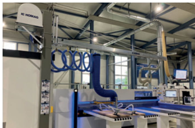
SSK-4000-100KG für das Handling großer Kartonagen
