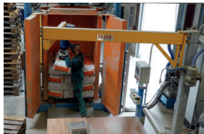
KSK-2500/2000-60KG mit Vakuum-Schlauchheber für die Sack-Handhabung
