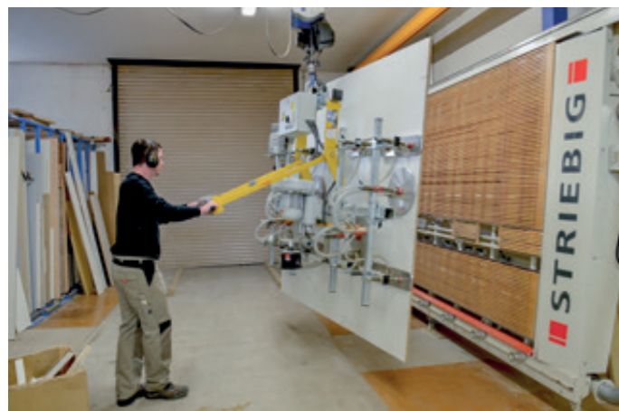
VacuPoro-90E-250KG zum Beschicken einer stehenden Plattenaufteilsäge
