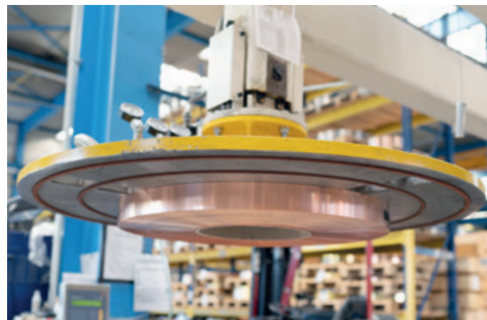
VacuCoil VCV-500KG an einer manuell betriebenen Hubachse zum Auslagern von Kupfer-Coils
