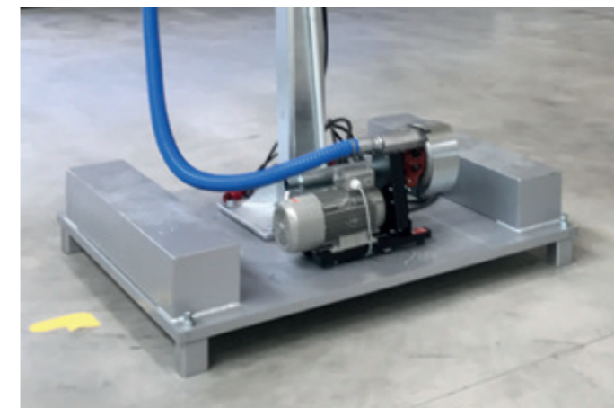
Mobile Grundplatte zum Versetzen mit Hubwagen oder Gabelstapler
