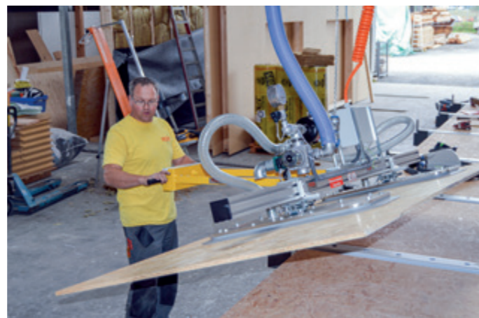
VacuPoro VP-500KG mit separat aufgestelltem Gebläse für OSB-Platten
