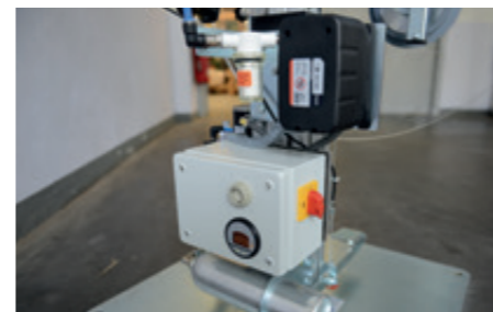
ACCU-Modul für netzunabhängigen Betrieb über einen Werkzeugakku und separates Ladegerät
