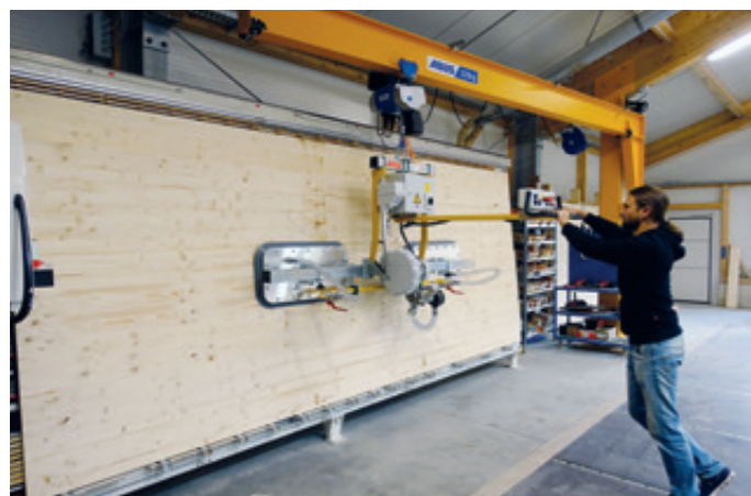
VacuPoro-90E-250KG zum Beschicken einer stehenden Plattenaufteilsäge
