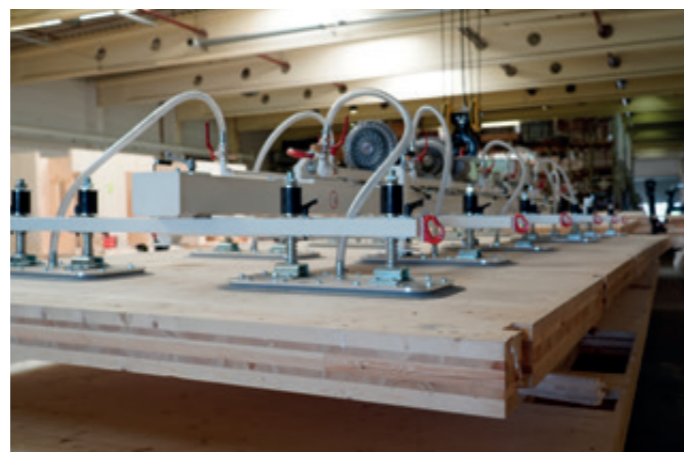
VacuPoro VP-1000KG in Sonderausführung mit 2 Vakuumgebläsen für den Transport von Mehrschichtplatten bis 10.000 mm Länge
