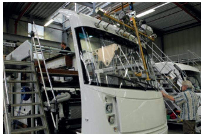
VacuBoy VB-VERT-125KG für die Montage von Frontglasscheiben
