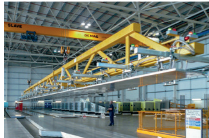
VacuGiant VG-5000KG Transport von bis zu 36.000 mm langen Aluminium-Rohplatten für die Tragflächenproduktion des Airbus A380
