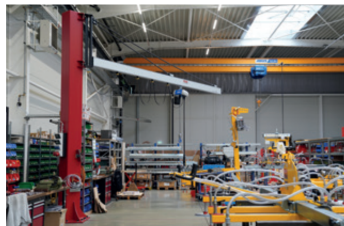
SSK-6000-500KG mit Kettenzug für den innerbetrieblichen Transport in der Endmontage
