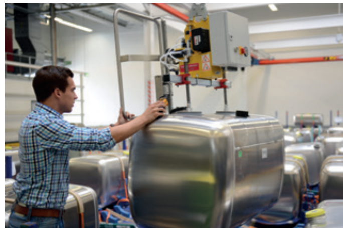
VacuBoyMini VBM-ACCU-75KG für den Transport von LKW-Tankbehältern mit 2-fach Aufsatz
