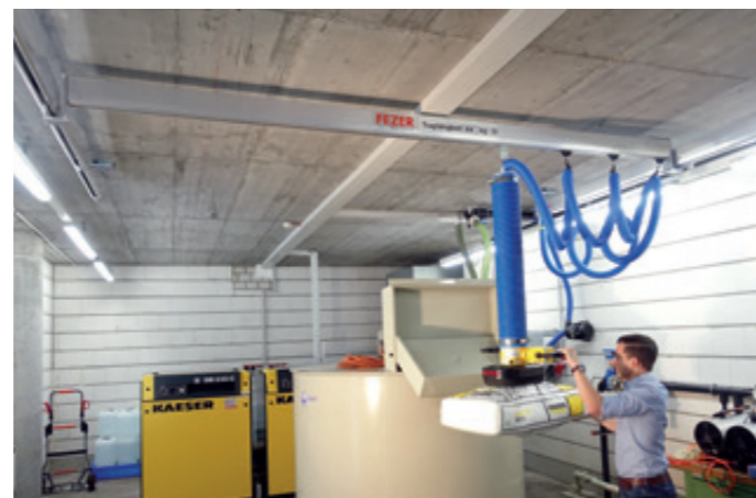
HBS-EBA-60KG-8000x4000 Einträgerkrananlage mit Aufbockung für geringe Bauhöhe bei max. Hubausnutzung
