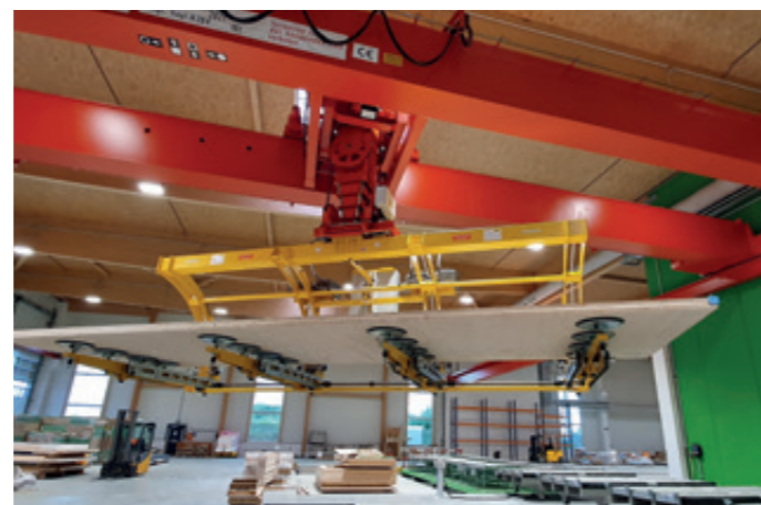
VacuGiant VG-180E-10000/2500KG mit austragenden Armen zum Wenden von 2.5000 kg schweren Holzplatten und dem horizontalen Transport von 10.000 kg schweren Beton-Bodenplatten
