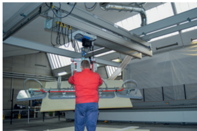
HBS-DB-500KG-8000x4000-TEL2000 Beschickung einer CNC-Bearbeitungsstation über teleskopierbare Doppelbrücke
