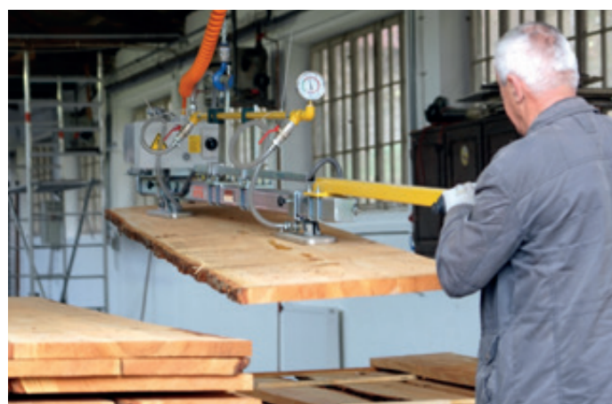
VacuWood VW-250KG Mit speziellen Sauggreifern für sägeraue Oberflächen
