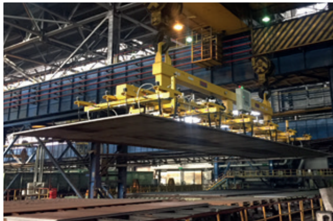
VacuGiant VG-25000KG für das Umsetzen von großformatigen Blechen bis 20.000 x 3.500 x 50 mm
