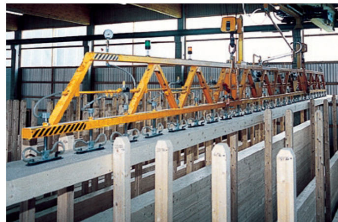
VacuWood VWLB-750KG für die Kommissionierung von 16.000 mm langen Hölzern in einem Runtenlager
