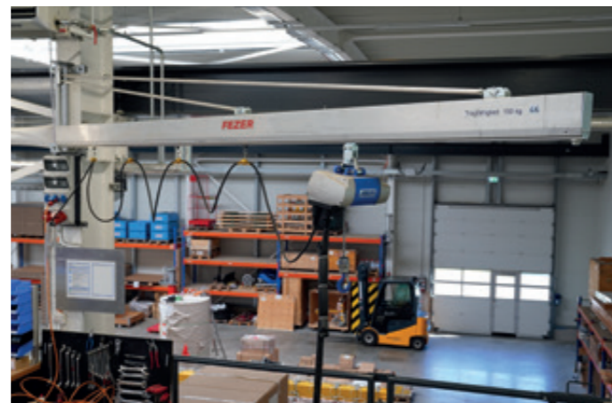
WSK-3000-150KG im Montagebereich einer Bauteilfertigung
