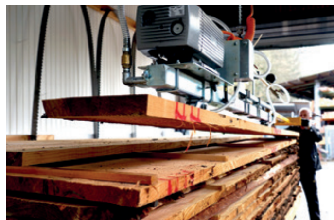
VacuWood VW-250KG Für den Transport von Hölzer bis 6.000 mm
