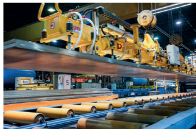
VacuGiant VG-12000KG-TEL in niedriger und teleskopierbarer Bauweise für Aluminiumbleche bis 14.000x3.000x100 mm
