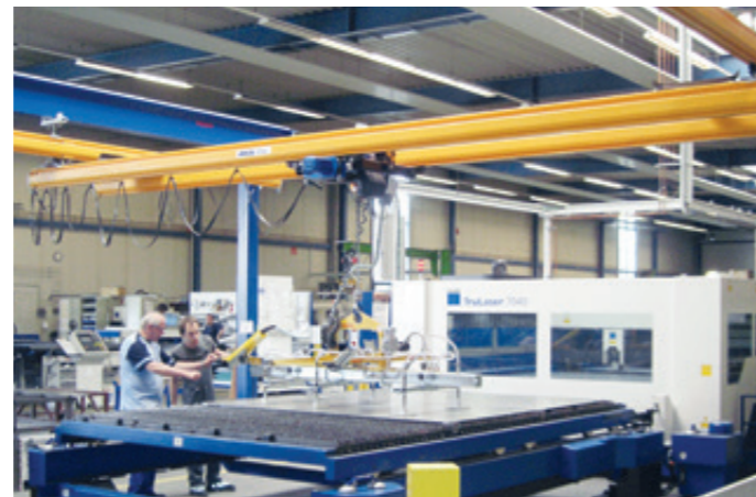
HBS-DB-800KG-6000x8000 Zweiträgerkran zum Überspannen einer Brückenlänge von 8.000 mm
