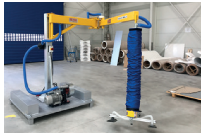
KSK-2000/2000-125KG mit mobiler Grundplatte und einem Vakuum-Schlauchheber
