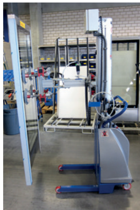
MobiliftMini ML-100KG-2000 mit manueller Dreheinheit für Fensterelemente
