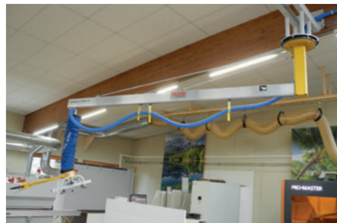
DSK-3500-100KG mit 360°-Schwenkbereich zum Bestücken einer CNC-Maschine
