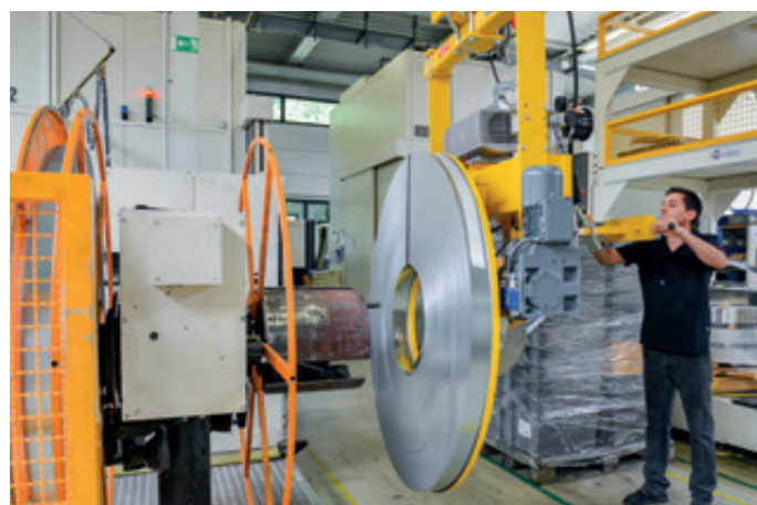
VacuCoil VC-90E-1000KG für Aluminiumspaltbänder bis 1.800 mm Durchmesser
