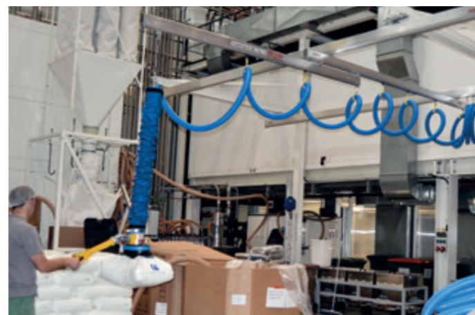
HBS-EB-60KG-6000x4000-TEL2500 Einträgerkrananlage mit teleskopierbarer Einzelbrücke zur Aufnahme von Säcken außerhalb des Arbeitsbereiches
