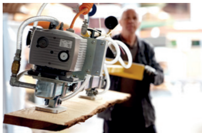
VacuWood VW-250KG Beim Umstapeln von Holzbohlen nach einer Aufteilsäge.
