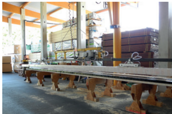
VacuWood VWLB-250KG für das Umschichten von bis zu 12.000 mm langen Hölzern
