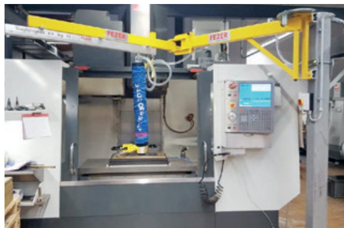
KSK-2500-2500-80KG für die Beschickung einer Bearbeitungsmaschine
