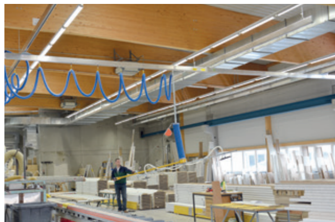
HBS-EB-80KG-16000x12000 Einträgerkrananlage mit 3 Kranbahnen für die Überspannung einer Brückenlänge von bis zu 12.000 mm
