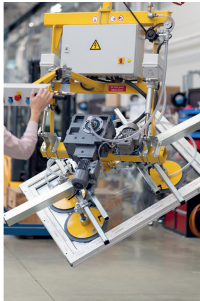
VacuBoy VB-90E-180E-500KG mit elektrischen Schwenk- und Drehantrieb bei der Handhabung von Fensterelementen
