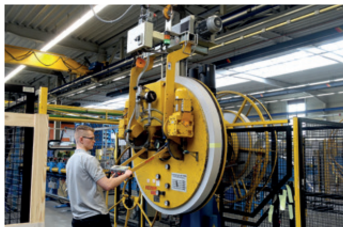
VacuCoil VC-90E-800KG für Kunststoffspaltbänder in der Produktion von Rolladenelementen
