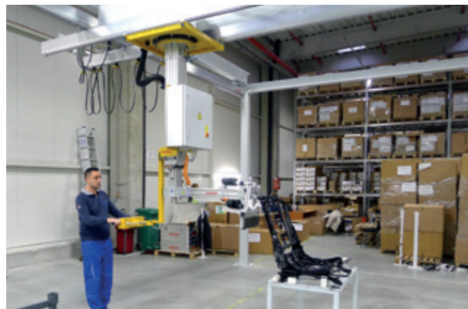
Lifffix LF-ET-50KG Starres Hubsystem mit Einfachteleskop und austragender Lastaufnahme für Sitzgestelle
