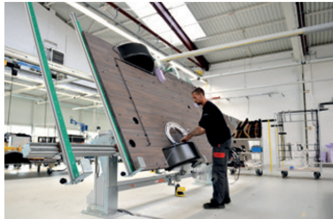
Schwenkstation SSS-90E-HV-150KG mit Höhenverstellung in der Vormontage von Wohnmobilmöbeln
