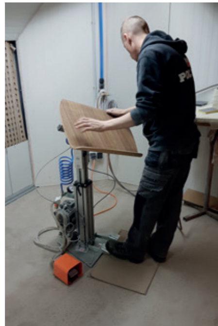
VacuStand VS-I-25KG mit Rastmodulen und Fußbedienung für die Bearbeitung von Sitzflächen für Stühle
