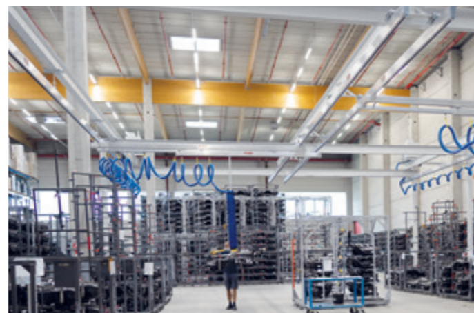
HBS-EB-80KG-12000x4000-TEL1500 teleskopierbare Einzelbrücken an einer Mehrträgerkrananlage
