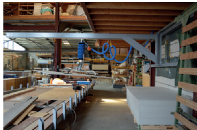
WSK-KA-125KG mit Kragarm-Ausführung für niedrige Bauhöhe
