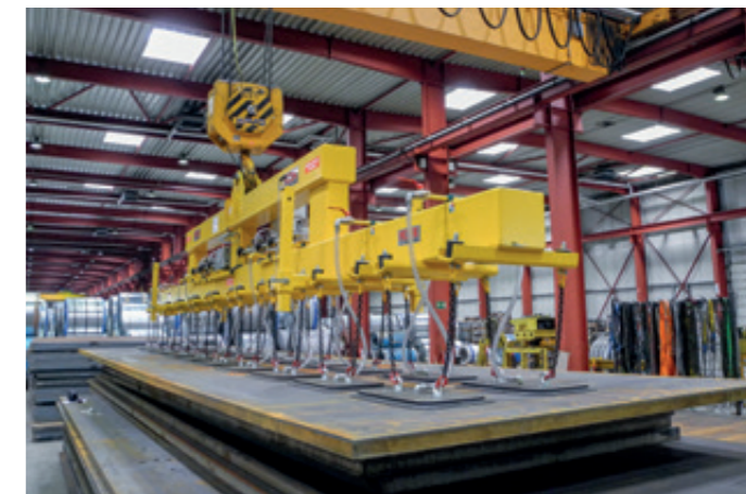
VacuGiant VG-25000KG mit doppelreihiger Saugplattenanordnung für den Transport von Stahlblechen bis Abmessungen von 14.000 x 3.000 mm
