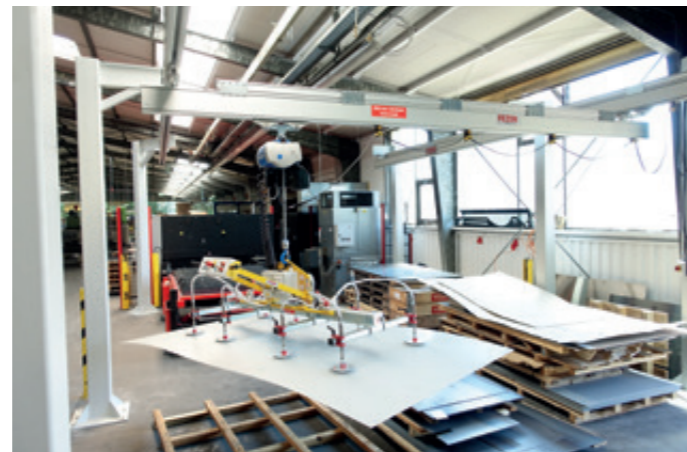
HBS-EB-500KG-12000x6000 Einträgerkrananlage mit verstärkter Brücke für höhere Belastung
