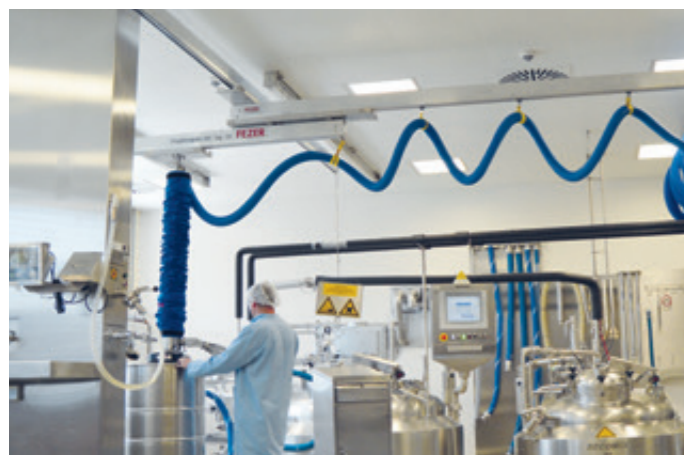
HBS-EB-80KG-10000x4000-TEL1500 Einträgerkrananlage mit teleskopierbarer Einzelbrücke
