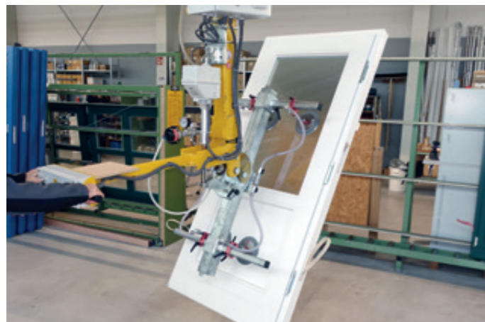
VacuBoy VB-90E-180-125KG mit elektrischem Schwenkantrieb und manueller Drehvorrichtung in der Produktion von Fenster- und Türelementen
