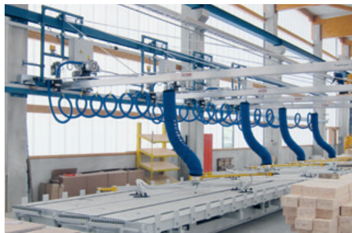
VacuBoy VB-90E-250KG für großflächige Stahlplatten bis 4.000x2.000 mm
