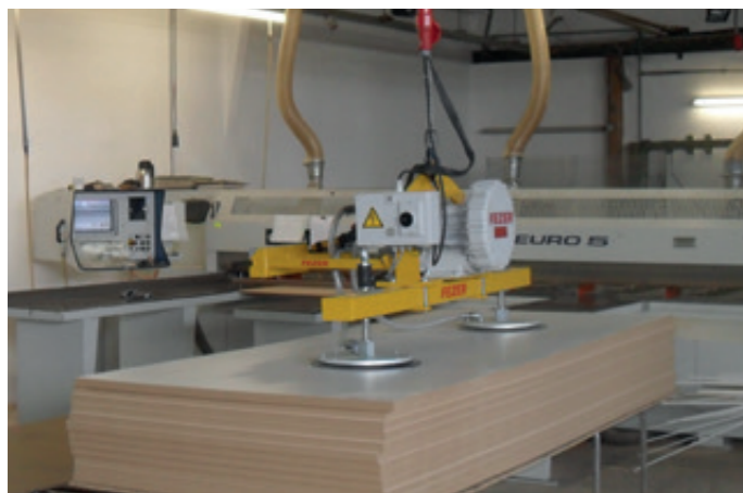
VacuPoro VP-250KG für das Handling roher und beschichteter Spanplatten
