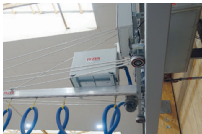
VacuBoy VB-90E-1500KG Transport von Stahlblechen bis 3.000x2.000 mm
