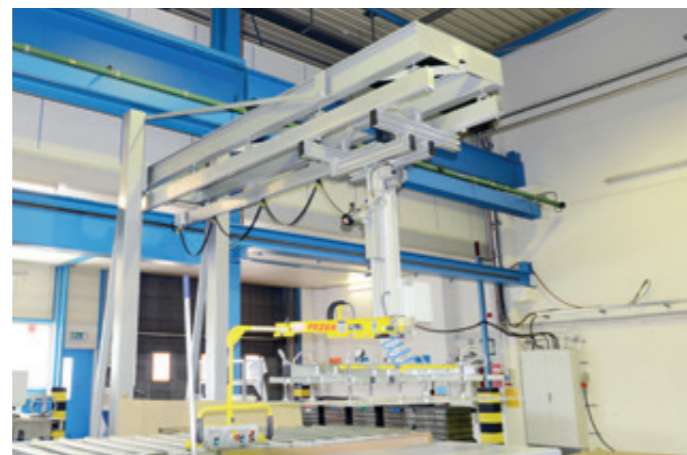
HBS-ZS-500KG-6000 Zweischienenkrane mit Liftfix für die Blechbeschickung einer Laserschneidanlage
