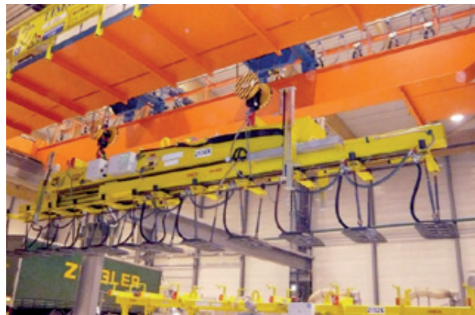
VacuGiant VG-12000KG-TEL elektromotorisch ausziehbare Schwerlasttraverse für Bleche von 8.000 - 14.000 mm im eingefahrenen Zustand
