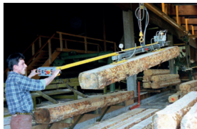
VacuWood VW-500KG Beim Zuführen von Holzstämmen an eine Gittersäge.
