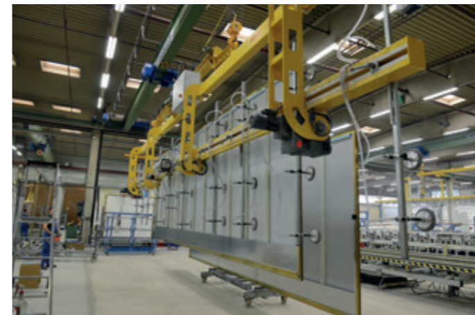
VacuGiant VG-VG90-2500KG Schwenktraverse mit Drehwerk für die Montageunterstützung von LKW-Aufbauten
