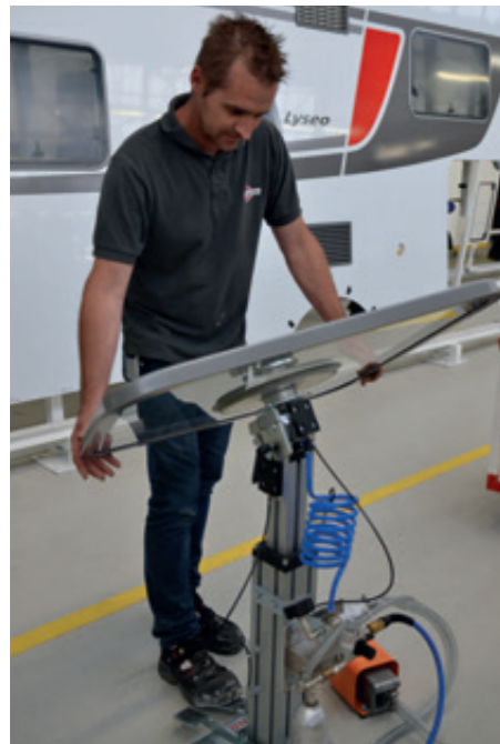
VacuStand VS-I-50KG mit Rastmodulen und Fußbedienung bei der Vormontage von Fensterelementen
