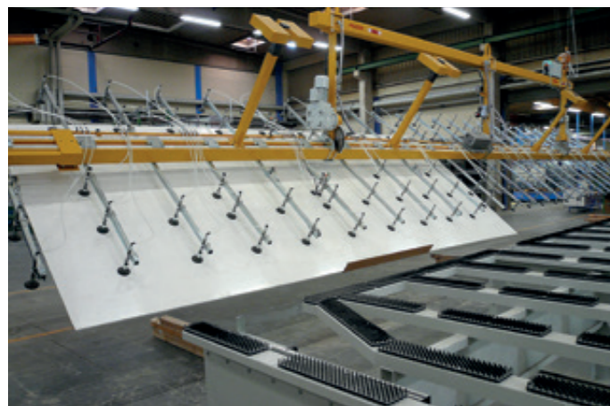
VacuGiant VG-90E-2500KG für LKW-Seitenteile bis 13.500 mm Länge
