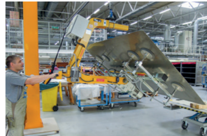
VacuBoy VB-180E-500KG für großflächige Stahlplatten bis 4.000x2.000 mm
