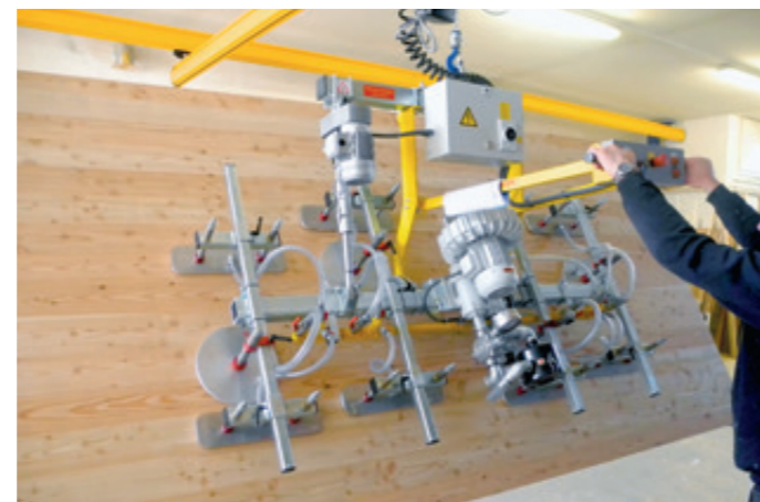
VacuPoro-90E-250KG für das Umsetzen stehend gelagerter Span- und OSB-Platten
