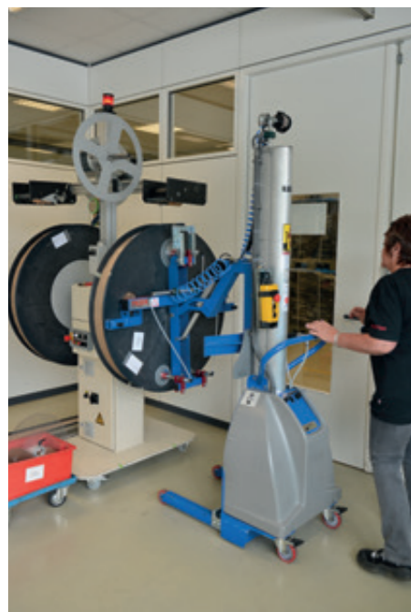
MobiliftMini ML-100KG-1500 für die Beschickung eines Haspeldornes mit Kupferspulen
