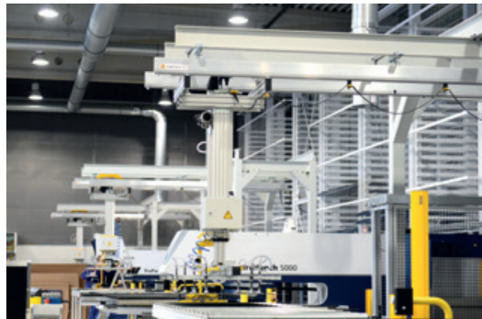
Lifffix LF-DT-250KG Starres Hubsystem mit Doppelteleskop für die Handhabung von Stahlplatten
