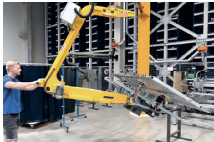
VacuBoy VB-180E-250KG Wenden von aufgekanteten Stahlplatten
