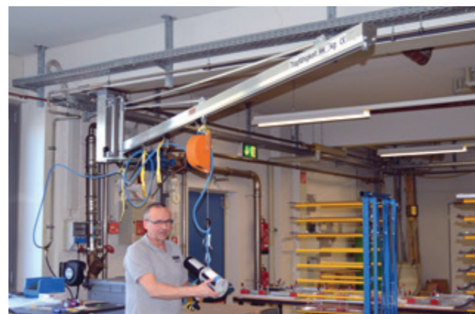
DSK-5000-50KG mit Schwenkbegrenzer und Balancer-Zug
