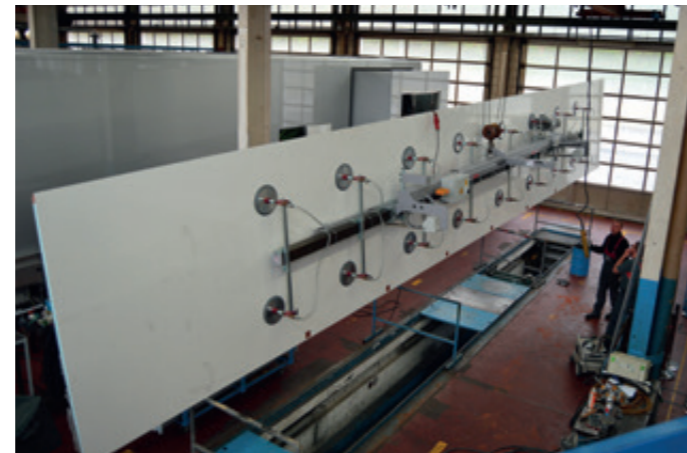
VacuBoySystem VBS-90E-1.000kg für die Montageunterstützung von LKW-Seitenteilen bis 12.000 mm Länge
