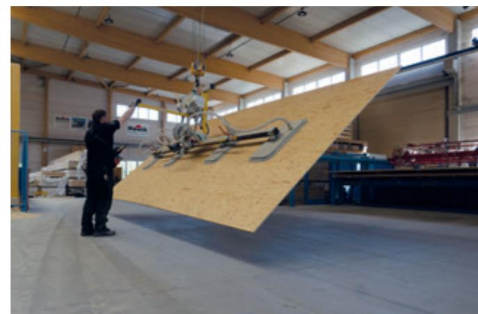
VacuPoro-90E-500KG zum Beschicken einer liegenden Plattenaufteilsäge
