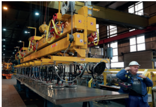
VacuGiant VG-12000KG-TEL elektrisch teleskopierbare Vakuumtraverse für die Beschickung einer Reckbank
