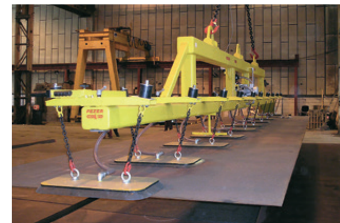
VacuGiant VG-12000KG mit einreihiger Saugplattenanordnung für Stahlbleche bis 20.000 x 3.500 x 50 mm
