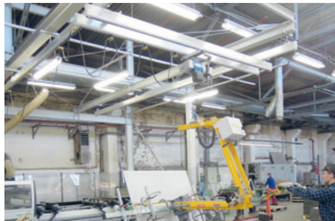
HBS-DB-500KG-8000x6000 Zweiträgerkran mit einer Spannweite von 6.000 mm
