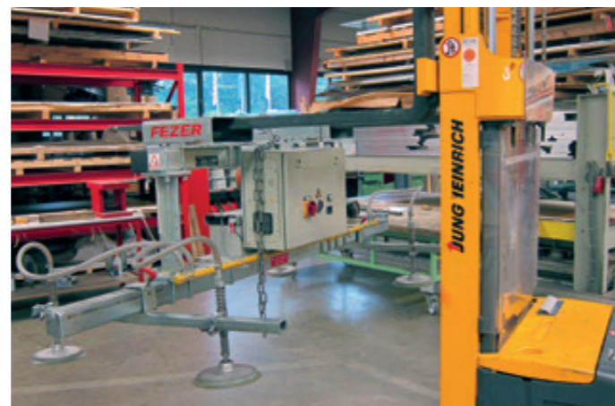
VacuBoyForker VB-250KG zum Umlagern von Stahlblechen
