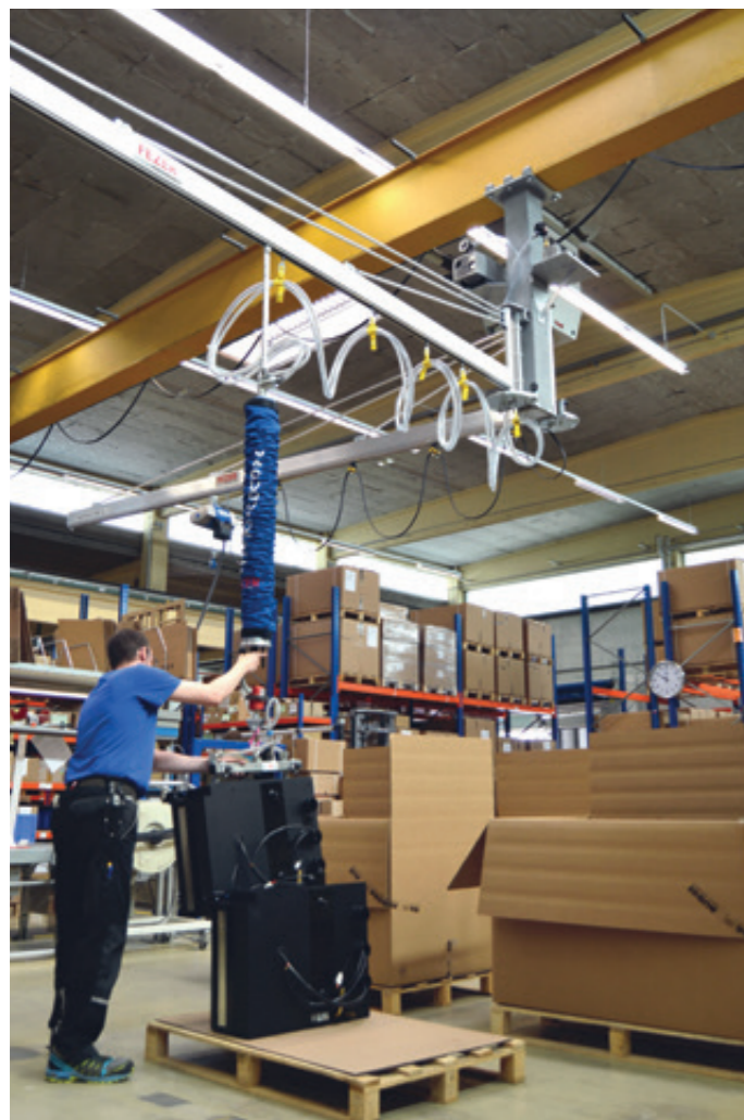
DSK-4000-50KG zum Unterfahren einer bestehenden Kranbahn
