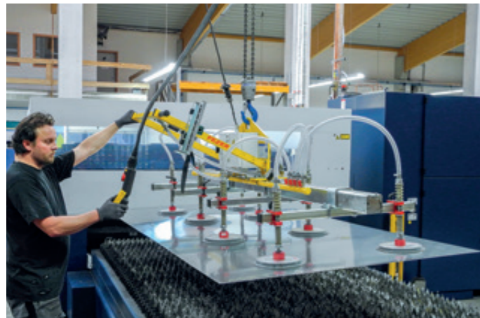
VacuBoy VB-500KG beim Beschicken einer CNC-Maschine
