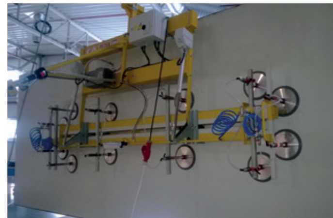
VacuBoySystem VBS-90E-1500KG für das Schwenken von beschichteten Platten
