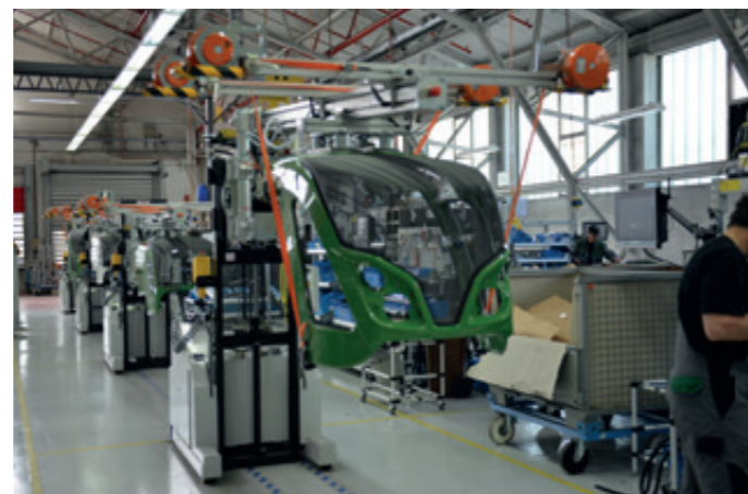
MobiliftMaxi ML-2000-500KG in der Vormontage von Motorhauben mit Zusatzsicherung für Überkopf-Montage
