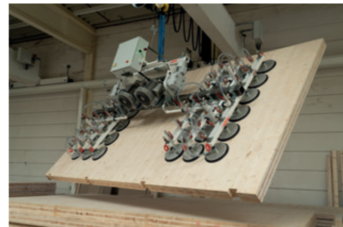
VacuGiant VG-90E-2500KG in der Endmontage von Raummodulen aus Holzelementen
