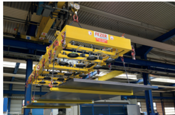
VacuGiant VG-5000KG-TEL Kombitraverse für den Transport von Einzelblechen mit Vakuum sowie kompletten Blechpaketen
