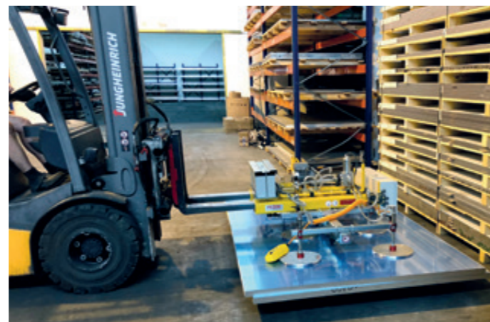
VacuBoyForker VBF-250KG-BATT mit autark arbeitenden Batterien für das Kommissionieren von großformatigen Blechen
