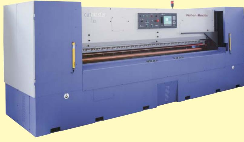
Die kompakte Zweimesserschere garantiert einen parallelen Schnitt und höchste Qualität der Furnierkanten. Während das gesamte Furnierpaket vom Druckbalken fixiert wird, schneiden die beiden Messer die gewünschte Paketbreite.
