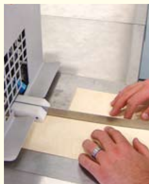
Automatischer Furniereinzug nach manueller Ausrichtung
