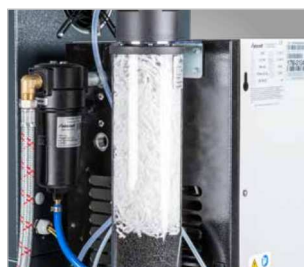
· Kondensataufbereiter zur Öl-Wasser-Trennung
