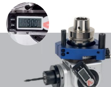
HSK F63 Schwenkaggregat, mit 1 Ausgang ER 25 für Bohr-, Fräs- oder Sägewerkzeug, digital, max. Ø 240 mm Winkeleinstellung und Schnellverschluss Best.-Nr. 300-24-026
