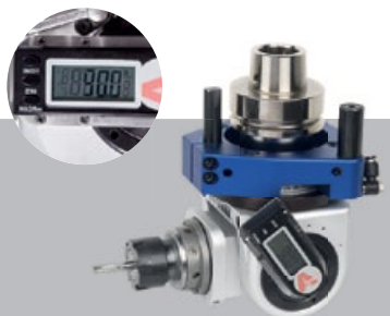
HSK F63 Schwenkaggregat, digital mit ET Schnittstelle für Bohr- Fräs- oder Sägewerkzeug, max. Ø 180 mm, Winkeleinstellung und Schnellverschluss Best.-Nr. 300-24-023
