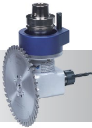
HSK F63 Zweifachwinkelkopf mit 1 Ausgang für Bohr- Fräswerkzeug ER 25 und 1 Ausgang WELDON mit verschraubtem Sägeblatt, max. Ø 180 mm Best.-Nr. 300-24-012
