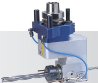
HSK F63 Schlosskastenaggregat mit 1 Ausgang ER 32 für Bohr- oder Fräswerkzeug mit zwei Druckluftausblasdüsen und 1 Ausgang hinten ER 16 für Bohr- oder Fräswerkzeug Best.-Nr. 300-24-017
