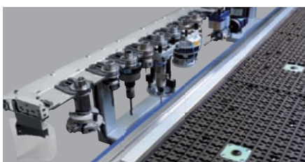
3 10-fach Linearwechsler hinten am Maschinenständer.
