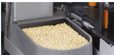
4 Leimaggregate mit optionalem Vorschmelzer
