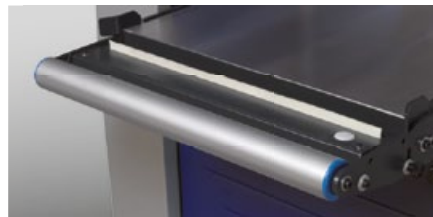
Für die Bearbeitung von nassen und harzreichen Hölzern lässt sich die Werkstück-Auflagerolle mit einer automatischen Gleitmittelaufbringung ergänzen.
