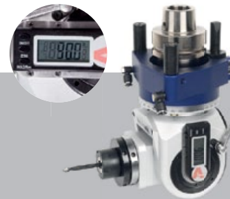
HSK F63 Schwenkaggregat, mit 1 Ausgang ER 25 für Bohr-, Fräs- oder Sägewerkzeug, digital, max. Ø 240 mm Winkeleinstellung und Schnellverschluss Best.-Nr. 300-24-026
