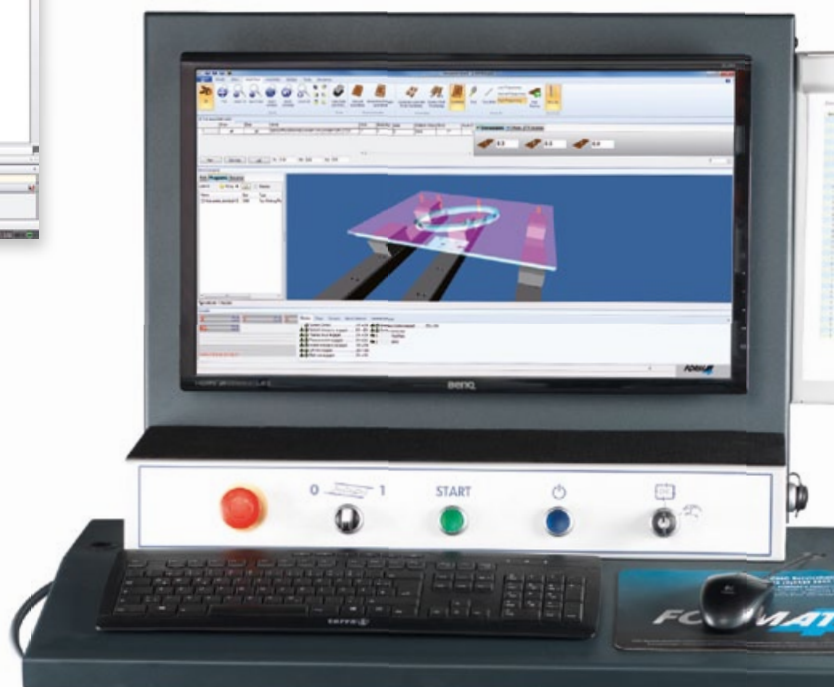
CNC-Editor: intuitive Dateneingabe Bei Format-4 beginnt CNC-Komfort bereits in der Planungsphase. Sparen Sie Zeit und Geld bei jedem Arbeitsschritt. → Programmieren der Einzelwerkstücke am Endmaß → DXF-Import als Standardlösung → Variables Programmieren, schnell und einfach → Einfache Verwaltung von Subprogrammen → Eine Vielzahl von Makros erleichtert das Programmieren auch bei komplexen Werkstücken
