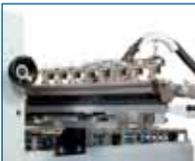
El grupo de aplicación de cola del Optimat FKP 100/DH se puede desplegar lateralmente para fines de trabajos de preparación y de mantenimiento.
