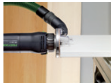
Abrunden von Kunststoff- oder Massivholzumleimern.
