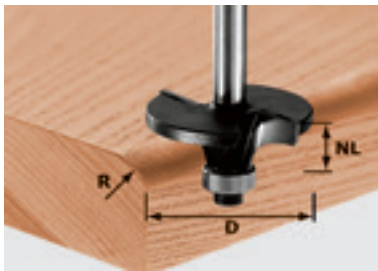
Profilfräser Radius HW mit Anlaufkugellager, Schaft 8 mm
