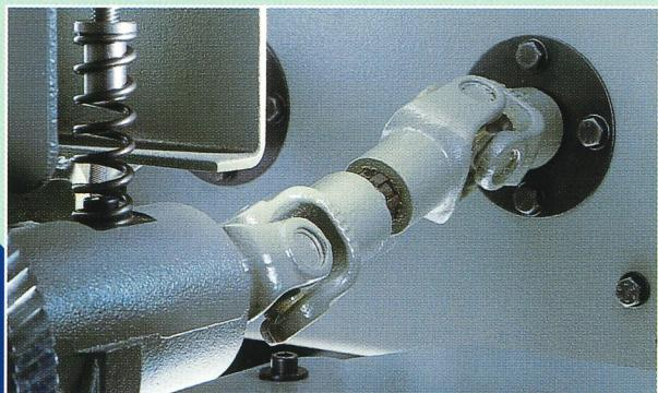
Il traino del pezzo avviene mediante giunti cardanici, ruote di traino in acciaio dentate e cementate.
