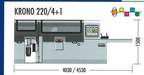
Il modello KRONO può essere fornito con larghezze di 180 mm a sezione finita e 220 mm in composizione da 4 alberi o 4 alberi più albero universale.
