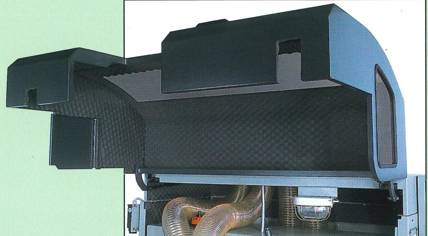
La cappa di protezione, rivestita all'interno di materiale fonoassorbente è conforme alle normative europee. All'interno della cappa è montata una lampada d'illuminazione d'esercizio. La cappa viene fornita di serie sulla macchina.
