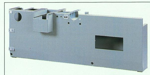
Il basamento della Krono è costruito in acciaio a struttura tubolare opportunamente nervato e stabilizzato, ciò conferisce un'alta rigidità e una conseguente assenza di vibrazioni.
