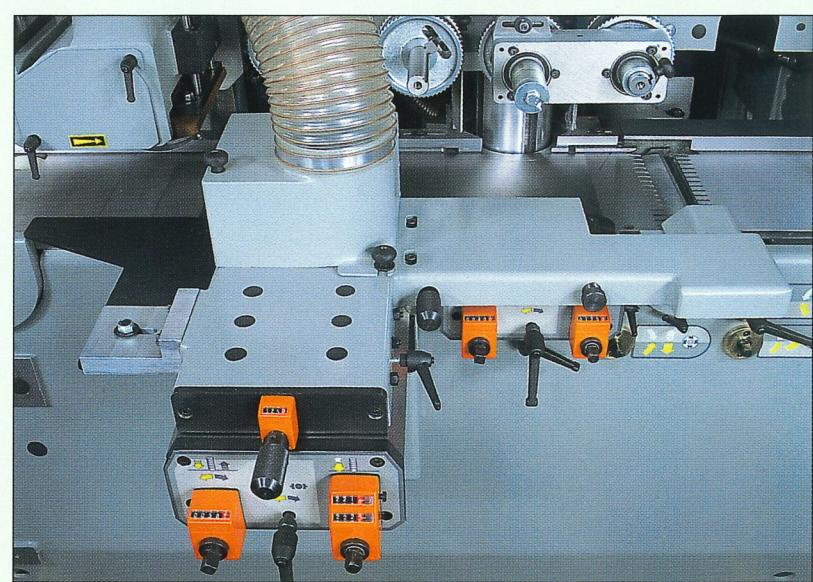
L'albero orizzontale superiore, nella versione Super ha la possibilità di alloggiare una fresa da 110 a 180 mm di Ø e può essere reso indipendente dai rulli di traino, pressori anteriori/posteriori e dalla cuffia. Si possono quindi montare fresa in profilatura e in quelle particolari lavorazioni dove occorre sfondare sul piano è possibile eliminare il pianetto sottostante ed eseguire la lavorazione stessa.
