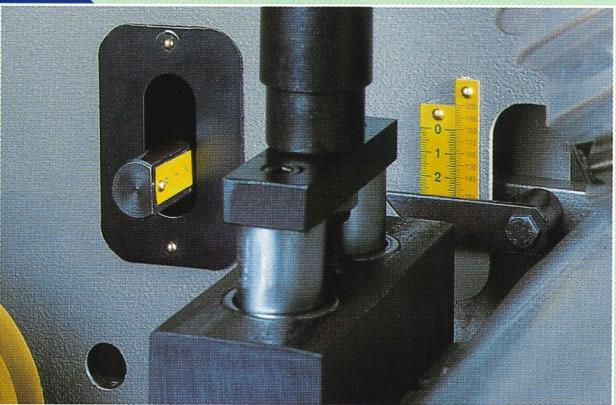
A differenza del modello KRONO, il modello KRONO SUPER può alloggiare utensili da 110 mm (min.) a 180 mm (max) di Ø su tutti gli alberi operatori (escluso la pialla a filo). Lo spostamento assiale del 4° albero (spessore) rispetto alla guida di dx è di 35 mm. Lo spostamento verticale rispetto al piano di lavoro è di 25 mm.
