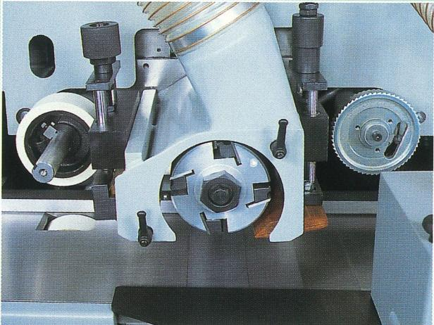
Il modello KRONO ha la possibilità di profilare sui due gruppi toupie con frese da 110 a 180 mm di Ø con spostamento assiale dalla guida e rispetto al piano da 0 a 25 mm. Il gruppo orizzontale superiore (spessore) ha la sola funzione di piallatura.
