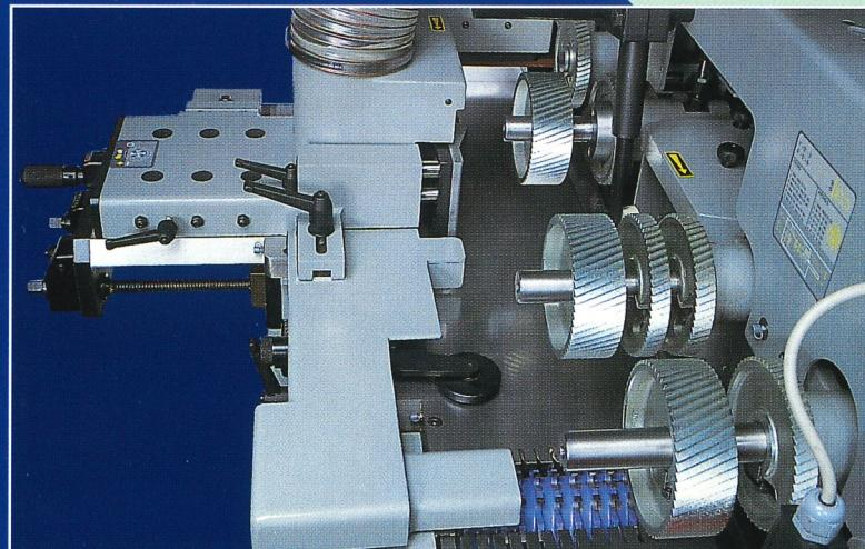
Ogni gruppo operatore è dotato di motore indipendente. Sulle versioni Krono e Krono Super possono essere montati motori da 10 HP su tutti i gruppi operatori. Per l'albero universale sono previste potenze sino a 15 HP.
