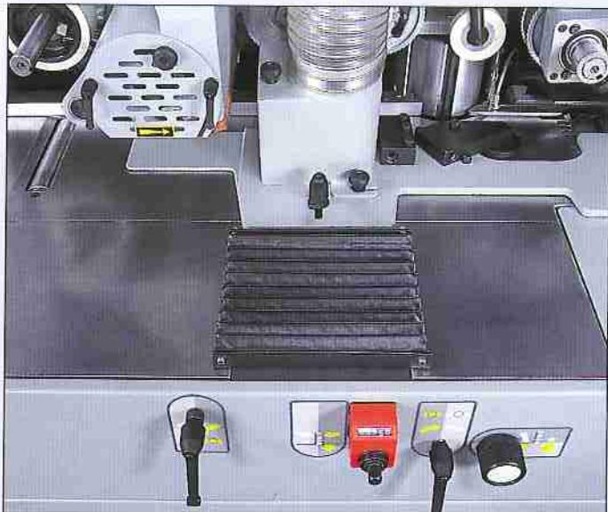
La fresa rasante (optional) abbinata alla testa orizzontale (optional) permettono un efficace e preciso raddrizzamento per pezzi aventi 10 mm (max) di svergolamento sui 4 lati.
