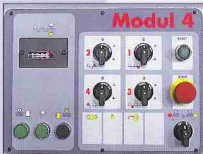
Il quadro comandi della Modul e Modul Super è razionale ed ergonomico. La discesa e salita del ponte, rulli di traino e dell'albero orizzontale è ad impulsi, per una registrazione rapida e precisa su misura decimale.
