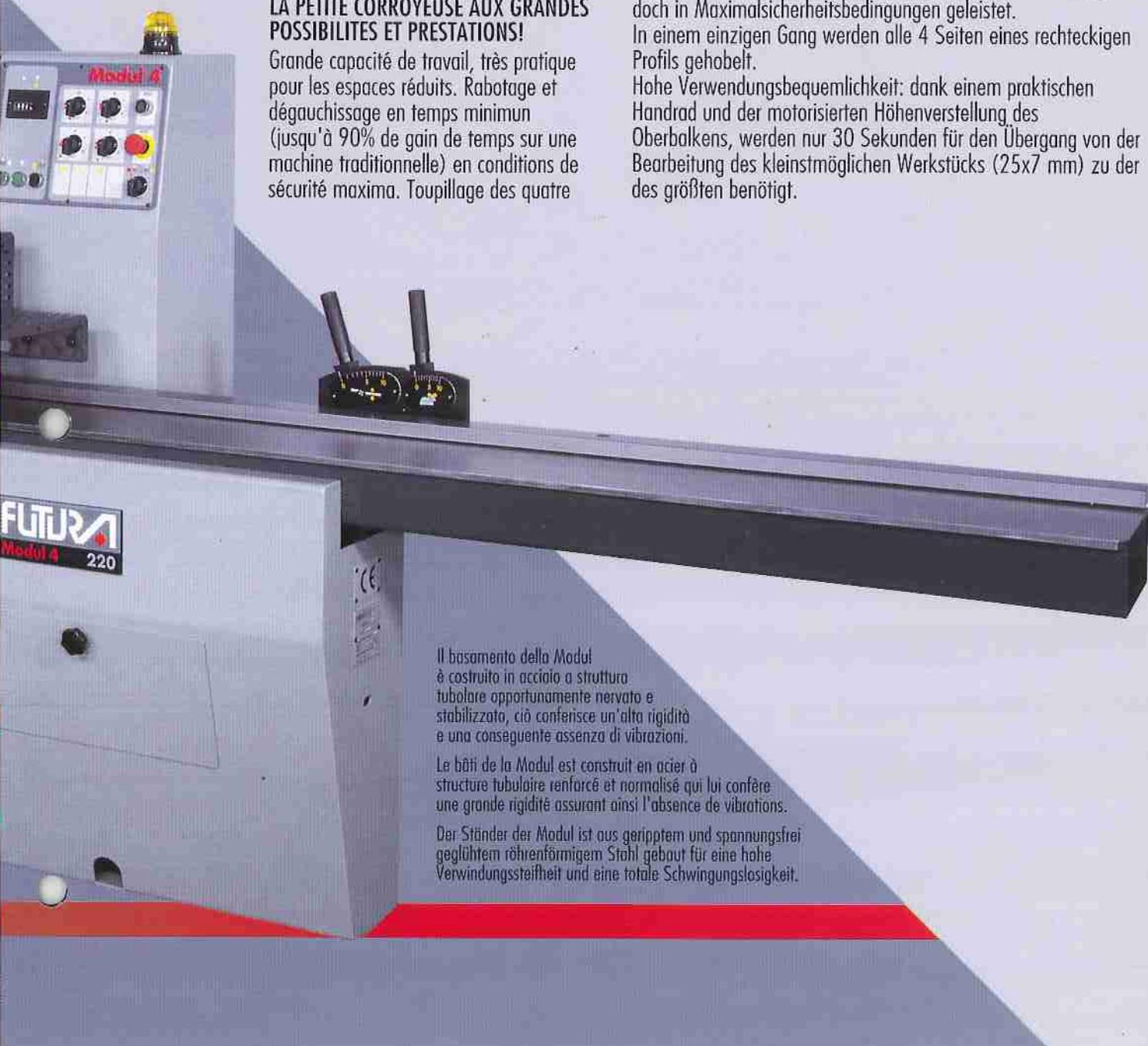
Il basamento della Modul è costruito in acciaio a struttura tubolare opportunamente nervato e stabilizzato, ciò conferisce un'alta rigidità e una conseguente assenza di vibrazioni.
