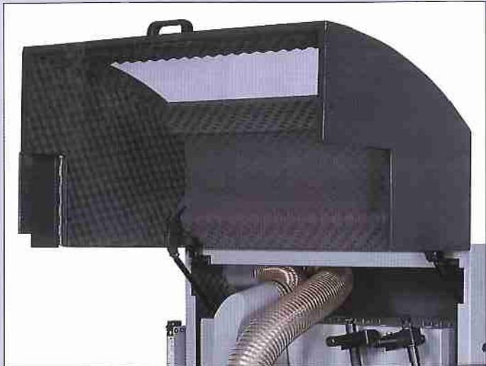
La cappa di protezione, rivestita all'interno di materiale fonoassorbente è conforme alle normative europee. La cappa viene fornita di serie sulla macchina.
