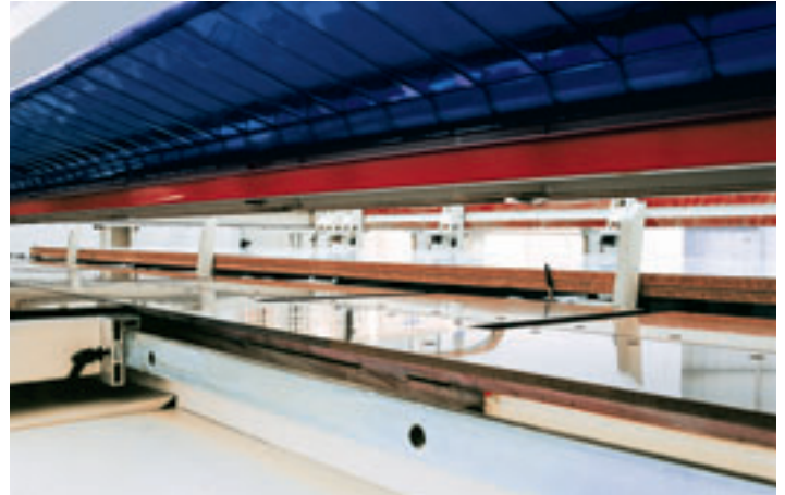
Allineatori frontali per il carico automatico Frontal aligners for automatic loading Aligneurs pour le chargement automatique
