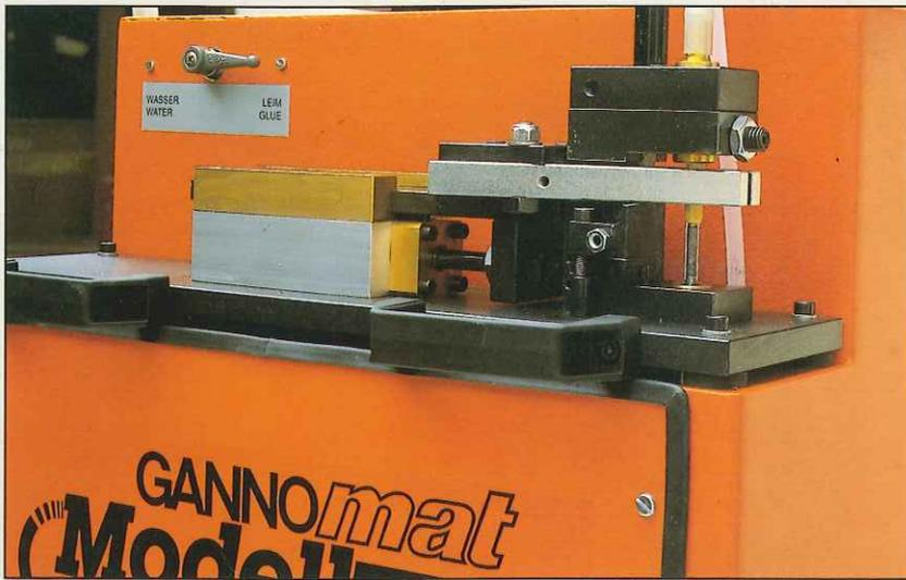
Übernahmestation mittels Zange und Stößel und automatischer Längenkontrolle + 2 mm
