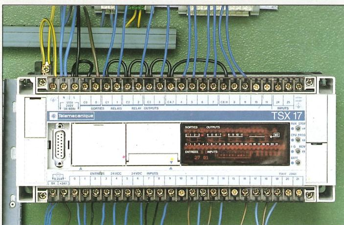
Wartungsfreie vollautomatische TELEMECANIQUE-Elektroniksteuerung mit Selbstdiagnoseprogramm
