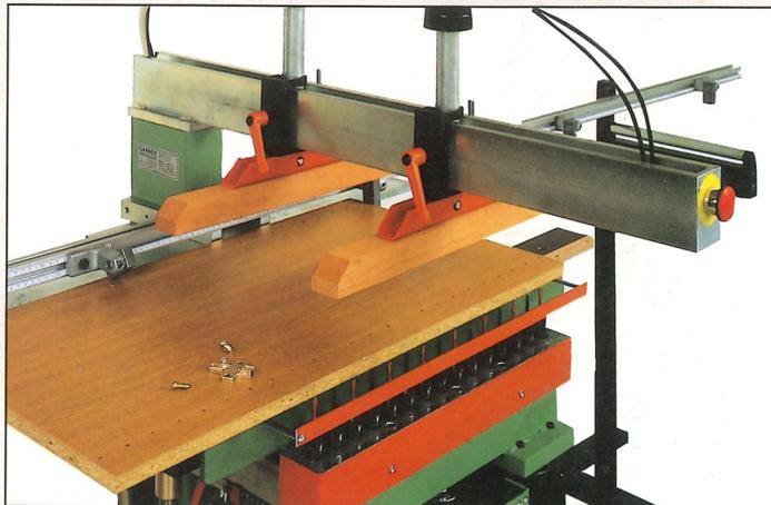
▲ Bohren von 2 Lochreihen im System 32, Taktanschläge mittels Einstelllehre fixiert.
