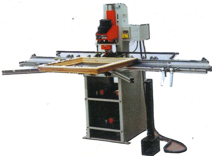
Abbildung zeigt Maschine zum Olivenbohren
