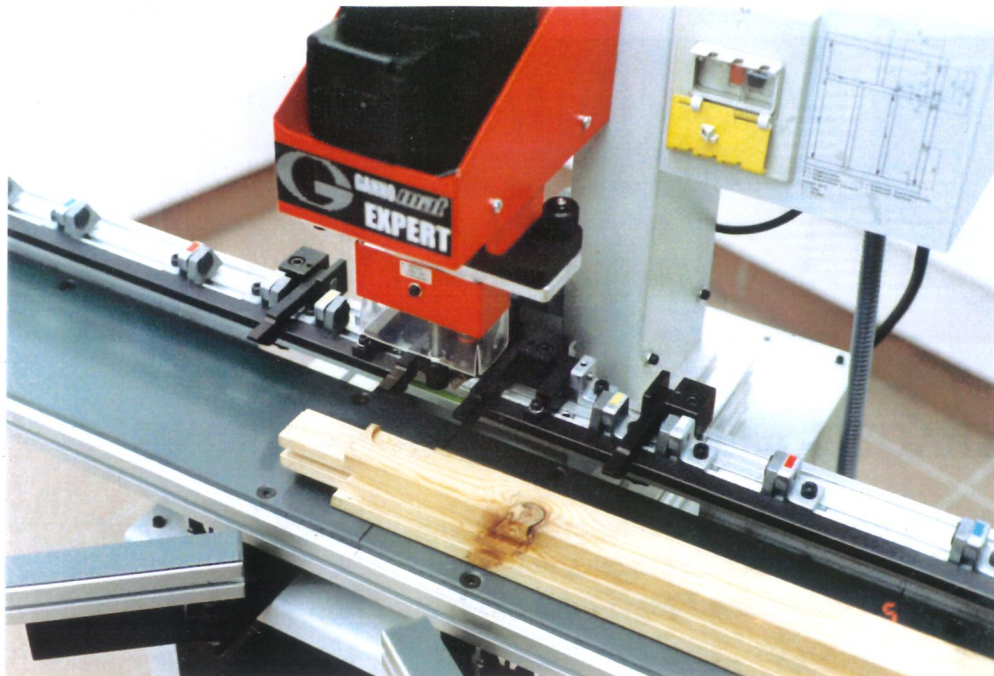
Abbildung zeigt Maschine mit Anschlagssystem für Ecklagerbohrungen
