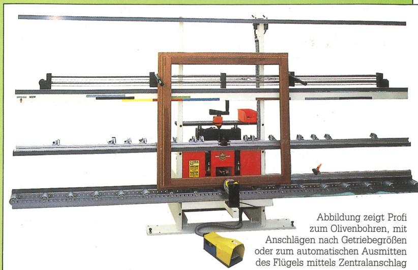
Abbildung zeigt Profi zum Olivenbohren, mit Anschlägen nach Getriebegrößen oder zum automatischen Ausmitten des Flügels mittels Zentralanschlag
