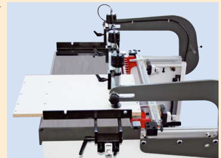
Seitenansläge mit mechanischen Digital-Zählwerken zum präzisen Einstellen des Randmaßes.
