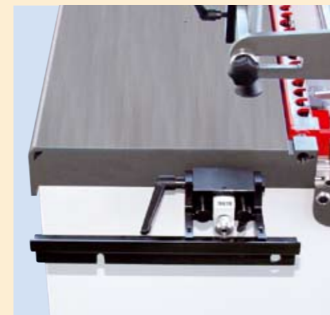
Seitenansläge mit mechanischen Digital-Zählwerken zum präzisen Einstellen des Randmaßes.
