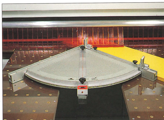
Vorrichtung für Gehrungsschnitte.
