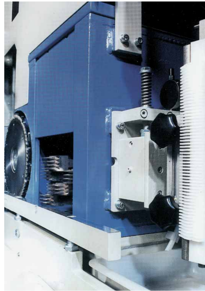
Flankenjet-Leimauftragssystem – genaue Dosierung, schnelle Umrüstung, Leimersparnis, kurze Reinigungszeiten
