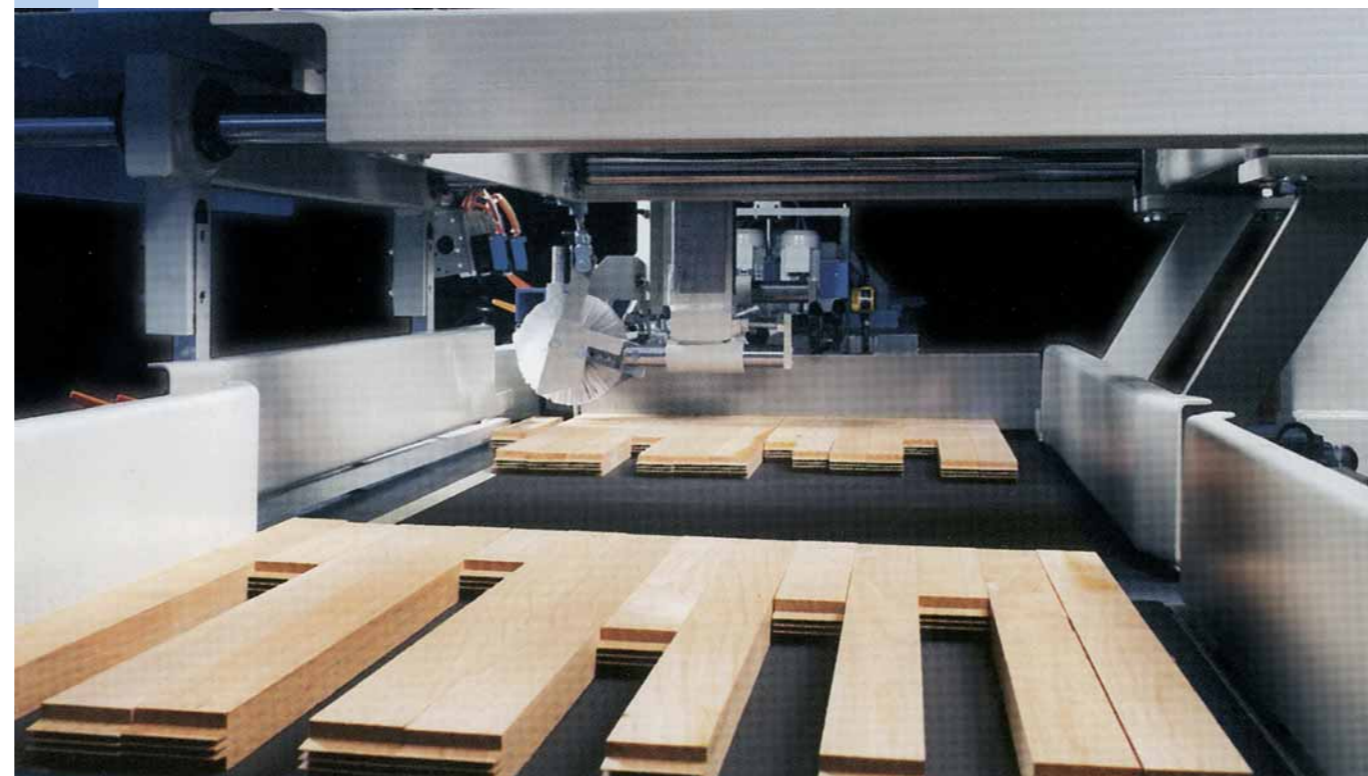
Automatische Übergabe zwischen Fräse und Presse – einstellbar für vertikale und horizontale Profile (bis 130 Teile/min)
