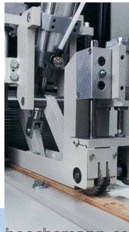
Vorschubsystem mit zwei angetriebenen Trommelmotoren (2 x 2,2 kW) – frequenzgeregelt
