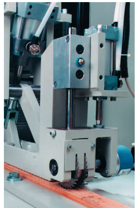
Längenmessung an der Vorverpressung
