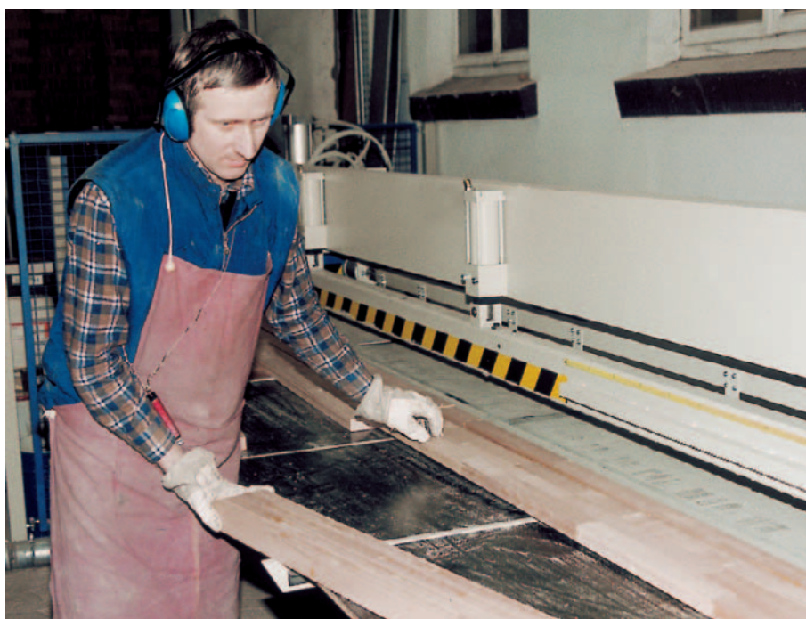
Ablegen der Hölzer nach dem Pressvorgang
