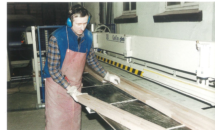
Ablegen der Hölzer nach dem Pressvorgang
