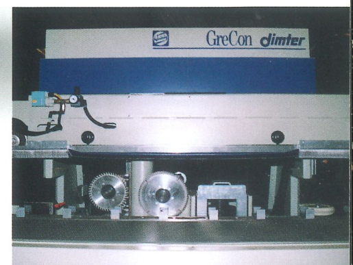
Ausrichtung der Hölzer im Einlaufbereich durch schräggestellte Rollen und Holzhöhenüberwachung
