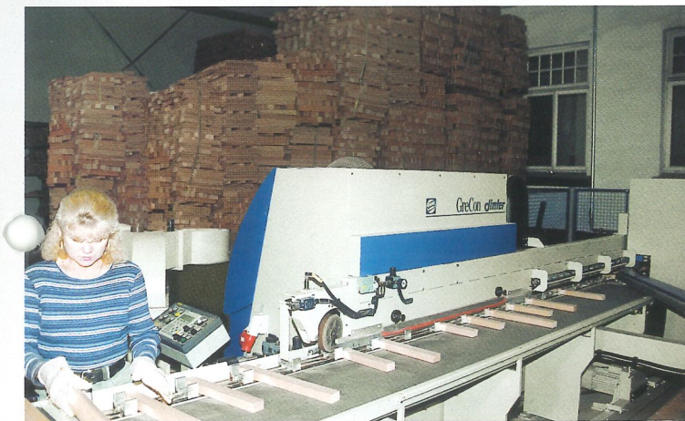
Manuelle Beschickung der Anlage
