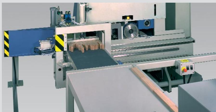
**Un standard d'outils remarquable** avec des scies inciseurs en haut et en bas, des déchiqueteurs et des fraises d'aboutage est à la base d'une production de profils précis. Les scies inciseurs sont synchronisées et empêchent ainsi des déchirures. L'entraînement indirect pourvoie aux réserves de haute capacité et un traitement sans vibrations des pièces courtes. C'est le seul traitement pour obtenir une jonction de bois absolument ferme.
