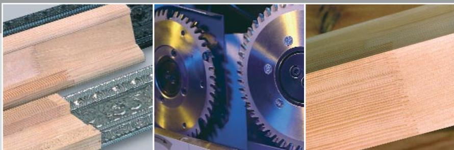
Grâce à la puissance d'avance des moteurs des tables de fraisage réglables en fréquences cette ligne offre une image de coupe régulière et précise sur toute la largeur du paquet.
