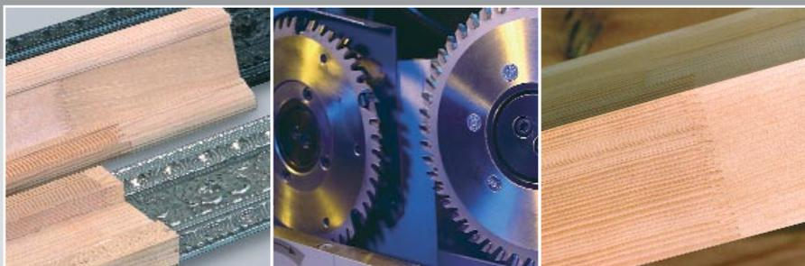
Grazie ai potenti motori del banco fresatura, controllati nell'avanzamento da convertitori di frequenza garantiscono a quest'impianto una fresatura regolare e precisa nella completa larghezza del pacco di legno.
