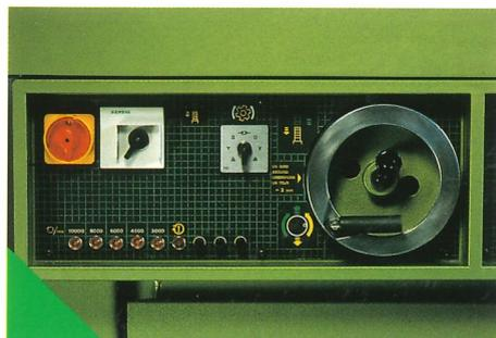
Dispositivo elettrico a normativa tedesca - indicatore di velocità inserita con spie luminose
