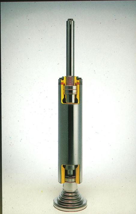
Sezione dell'albero con particolare dei 2 cuscinetti ad alta velocità accoppiati e precaricati
