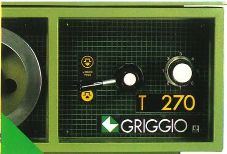
Comando per il posizionamento delle nr. 8 battute dell'albero
