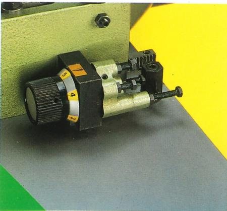
Dispositivo a revolver con n. 6 battute per il posizionamento rapido della guida
