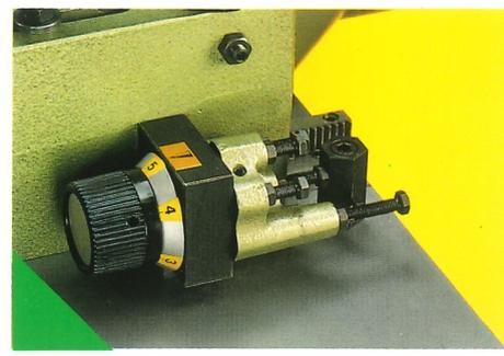
Dispositivo a revolver con n. 6 battute per il posizionamento rapido della guida
