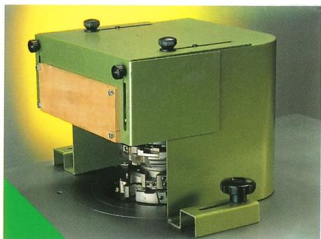
Protezione per tenonatura (utensili con diam. 340 mm max)
