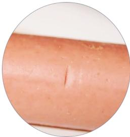
IL CAMBIO DI SEGNALE ELETTRICO ATTIVA IL PISTONE CON IL SISTEMA DI SICUREZZA. LA LAMA, DOPO IL CONTATTO, SI ALLONTANA DAL DITO CON UNA VELOCITÀ DI RETRAZIONE DI 5 MILESIMI DI SECONDO.
