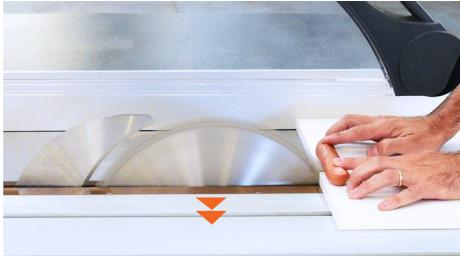
LA LAMA VIENE CARICATA SOTTO BASSA TENSIONE ELETTRICA. QUANDO LA PELLE TOCCA LA LAMA, IL SUO SEGNALE ELETTRICO CAMBIA PERCHÉ IL CORPO UMANO È CONDUTTIVO.
