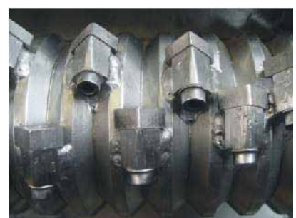
Profilrotor mit geschweißten Messerträgern (GAZ 62 S)
