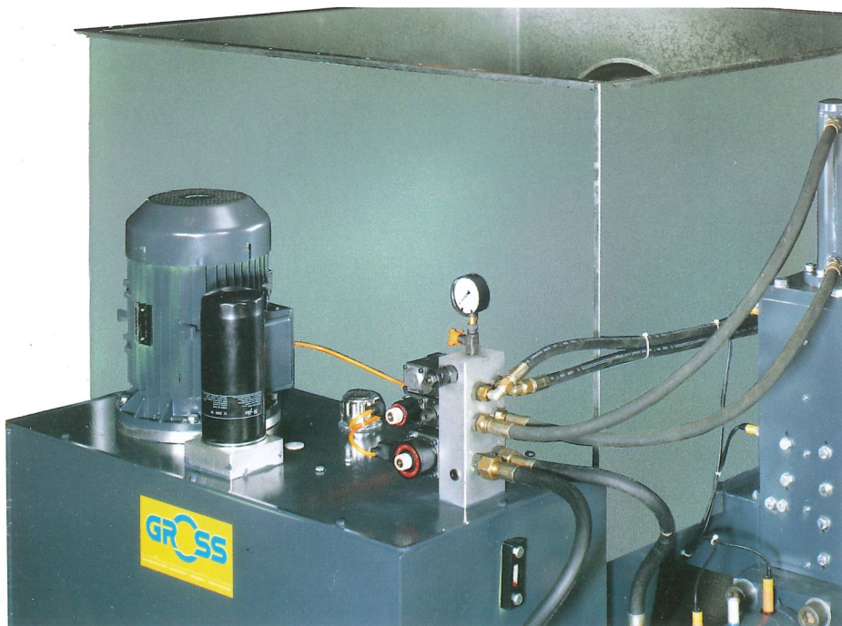
Leistungsstarker Hydraulikantrieb, je nach Anforderung 5,5 oder 7,5 kW
