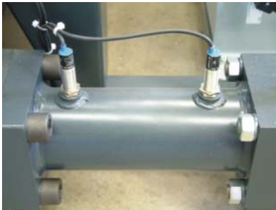
Verschleißfreie elektronische Sensoren Nonwearing electronic sensors
