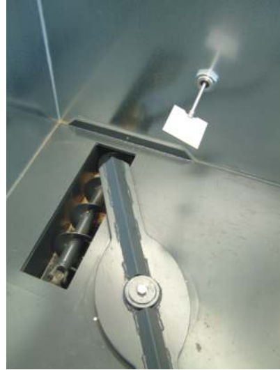
Rührwerk, Förderschneckenverdichter und Füllstandsmelder im Inneren Agitator, conveyor worm supercharger and level sensor inside
