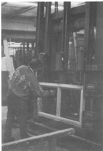
11 Maschinelles Zusammenbau an der Rahmenpresse. Die Beleimung und das Eintreiben der Dübel bei Setzhölzern und Sprossen soll schon bald ebenfalls automatisiert werden.
