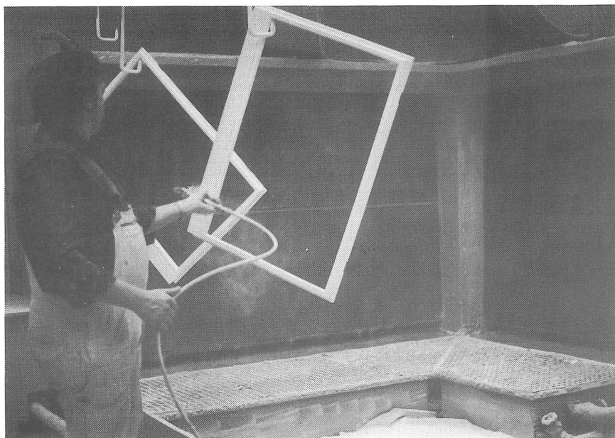
12 Kein Fassadenbauteil ungeschützt an die Baustelle. Unter diesem Motto wird seit ca. 15 Jahren im eigenen Haus lasiert und deckend lackiert. Die Umstellung auf wasserlösliche Beschichtungsmittel ist in vollem Gange.
