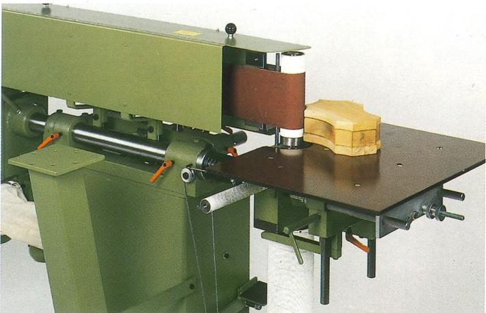
Ⓛ Schleifen von geschweiften Außenkanten mittels Anlauftring. Konsole für Vorschubapparat.
