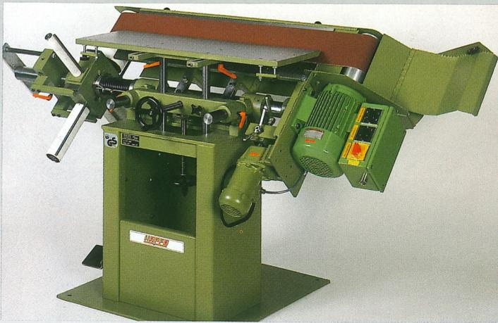
Ⓛ Das gesamte Schleifaggregat läßt sich nach vorne um ca. 20°, nach hinten um 90° schwenken. Bis zu einer Schrägstellung von 45° läßt sich der Auflagetisch bis an das Schleifband heranstellen.
