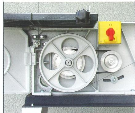
Stufenkeilriemenscheibe für 2 Geschwindigkeiten
