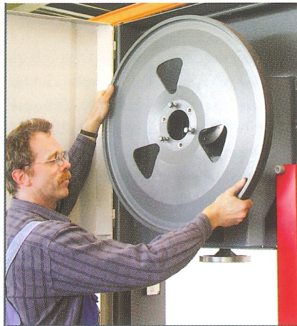
Ein typischer HEMA-Vorteil: Die angeflanschten Bandsägeräder können bei abgenutztem Gummibelag mit wenigen Handgriffen ausgetauscht werden.
