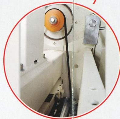
Breitband Poly-V-Riemen mit hoher Laufruhe und maximaler Kraftübertragung
