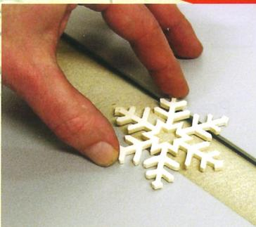
Die Tischwalzenschleifmaschine TWS 230 von HEGNER eignet sich hervorragend zum Schleifen von Laubsägearbeiten. Ideal zum Abschleifen von
